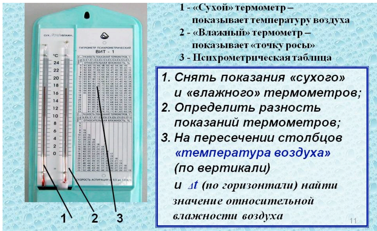
Рис. 2.1. Психрометр и алгоритм работы с ним
