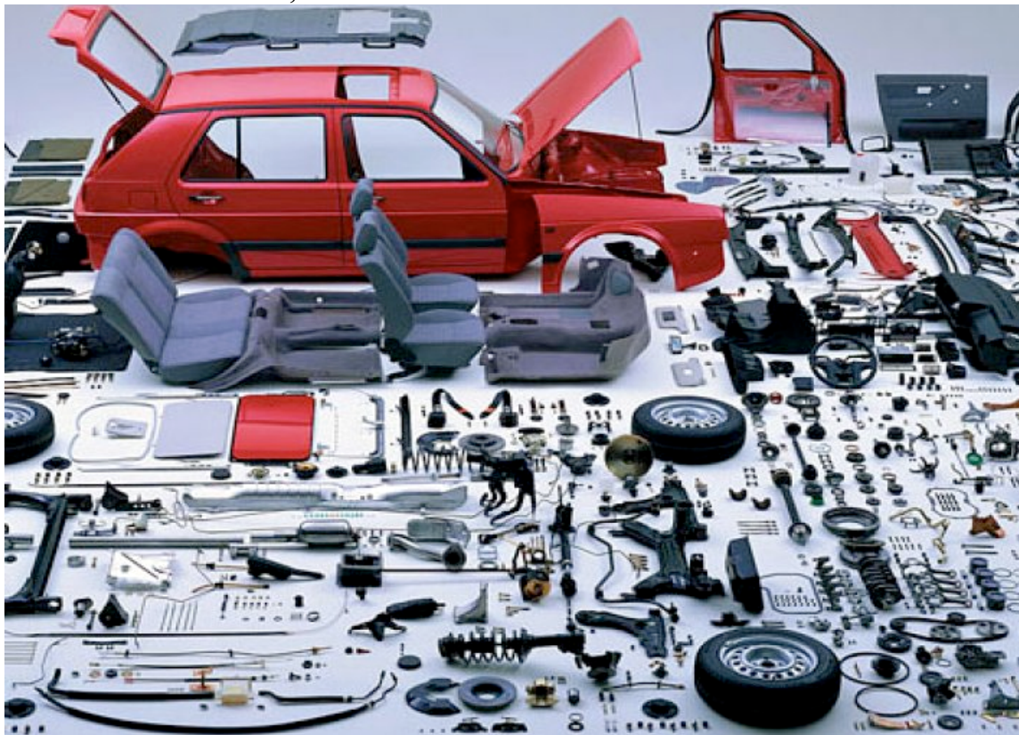
Рис. 3.4. Пример полной разборки автомобиля для утилизации или использования в качестве источника запасных частей
