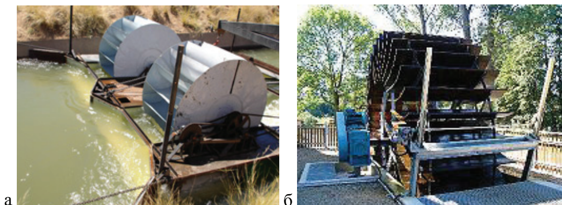
Рис. 3.49. Мини-ГЭС: а – плавающая на понтонах; б - с колесом Цуппингера и генератором. Германия, 2007 г.
