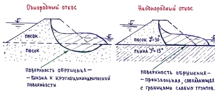
Рис. 4.20. Возможные виды обрушения низового откоса плотины [21]
