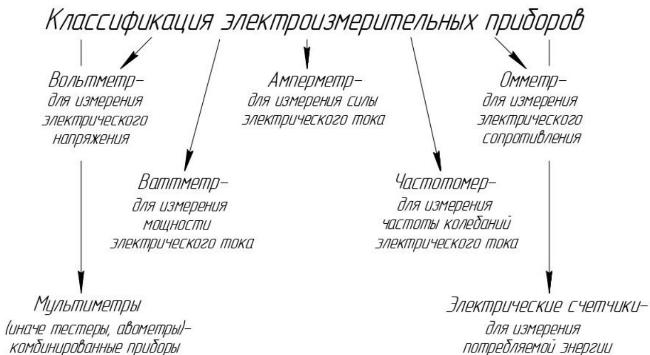
Рис. 2. Классификация электроизмерительных приборов прямого действия по роду измеряемой величины
