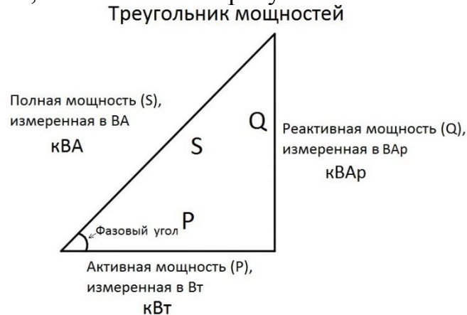
Рис. 2. Треугольник мощностей в системе переменного тока.
