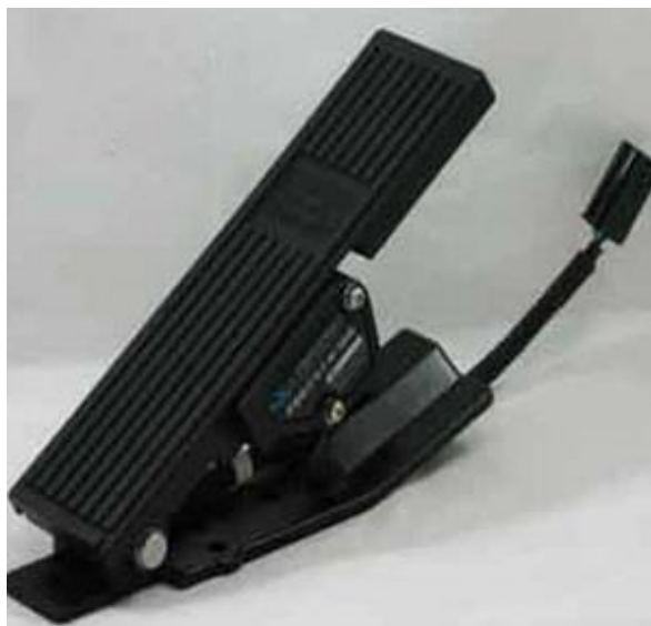
Рис. 1. Педаль акселератора, выполненная из пластмассы
