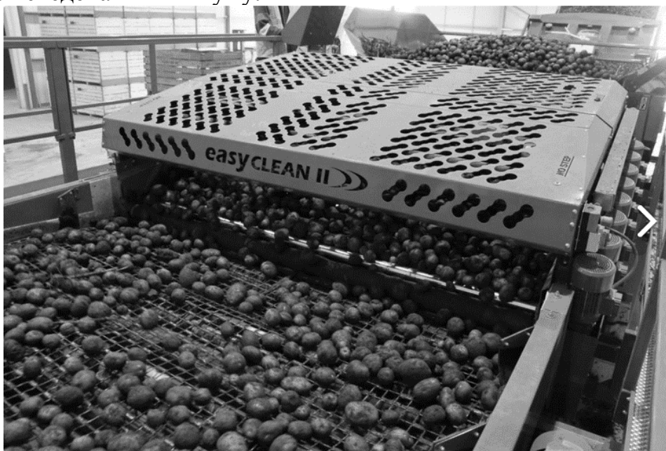
Рис. 2. Очиститель корнеплодов «Easy Clean II»
