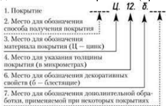
Рис. 2. Обозначение покрытия на чертежах
