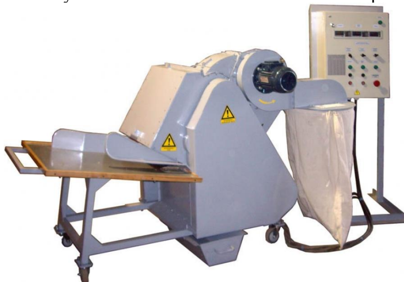
Рис. 5. Молотилка пучково-сноповая МСС-1 от ГСКБ «Зерноочистка»
