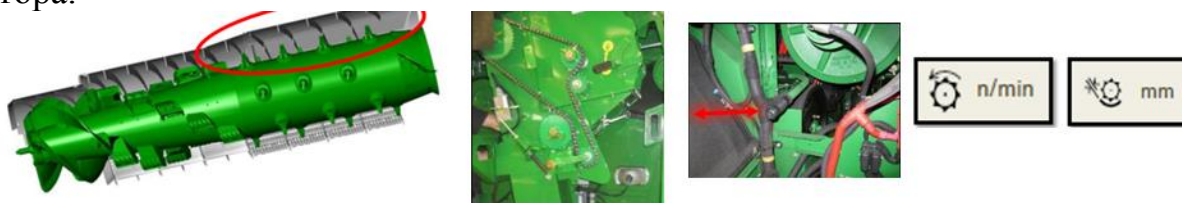
Рис. 3. Дополнительный молотильный аппарат и регулируемые верхние крышки
