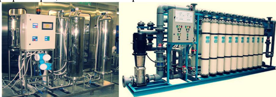
Рис. 1. Установка с ультрафильтрационными мембранами
