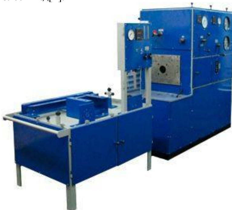
Рис. 2. Стенд для испытания и регулировки гидроагрегатов рулевого управления тракторов и комбайнов КИ-28097-02М
