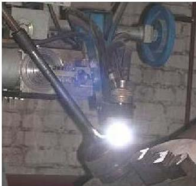
Рис. 3. Процесс плазменно-порошковой наплавки фаски клапана
