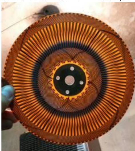
Рис. 3. Дисковый якорь с печатной обмоткой
