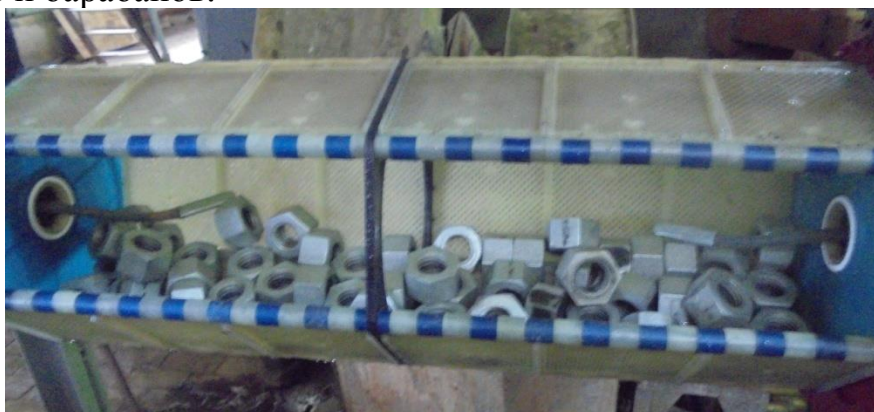
Рис. 1. Способ нанесения гальванических покрытий на мелкие детали с помощью барабанов
