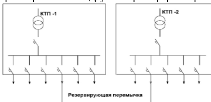
Рис. 5. Резервирование при электроснабжении от однострансформаторных ТП
