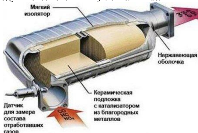
Рис. 3. Устройство автомобильного нейтрализатора
