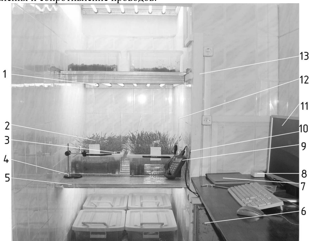
Рис. П1.8. Система импедансного контроля растений и почвы в вегетационно-климатической камере: 1 - облучательные лампы секции; 2 - контейнер с почвенно-растительными материалами; 3 - рН-метр; 4 - штатив; 5 - основание секции; 6 - пускорегулирующая аппаратура; 7 - журнал регистраций; 8 - набор электродов; 9 - измеритель иммитанса E7-22; 10 - датчик температуры воздушной среды; 11- монитор; 12 - термометр; 13 - кабельный канал
