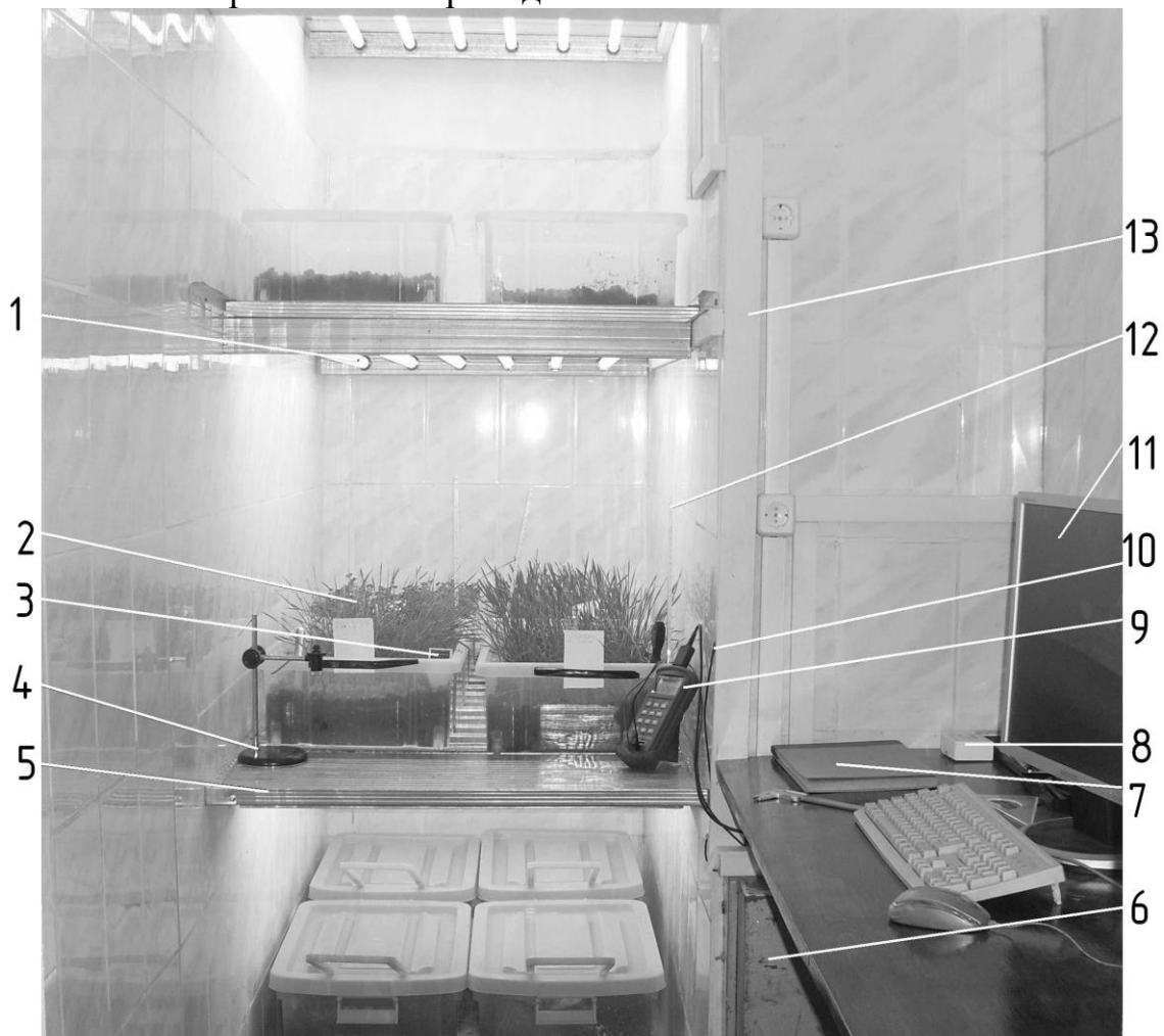
Рис. Пб.8. Система импедансного контроля растений и почвы в вегетационно-климатической камере: 1 - облучательные лампы секции; 2 - контейнер с почвенно-растительными материалами; 3 - рН-метр; 4 - штатив; 5 - основание секции; 6 - пускорегулирующая аппаратура; 7 - журнал регистраций; 8 - набор электродов; 9 - измеритель иммитанса E7-22; 10 - датчик температуры воздушной среды; 11- монитор; 12 - термометр; 13 - кабельный канал
