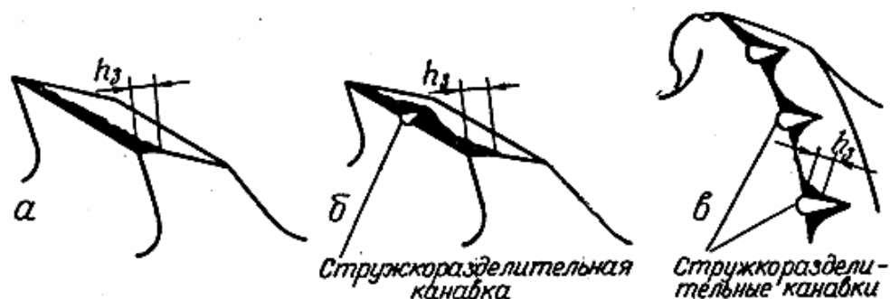
Рисунок 4.47 – Схема износа зубьев протяжки
