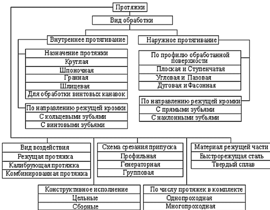
Рисунок 4.3 – Классификация протяжек
