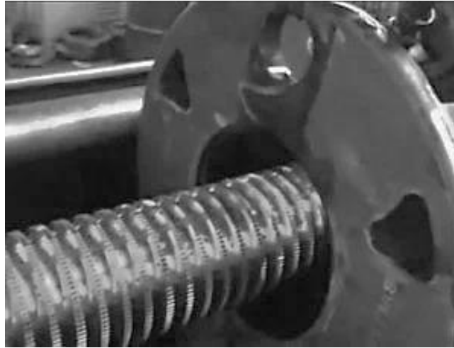
Рисунок 4.21 – Протягивание спиральных канавок Выбор схемы резания при протягивании
