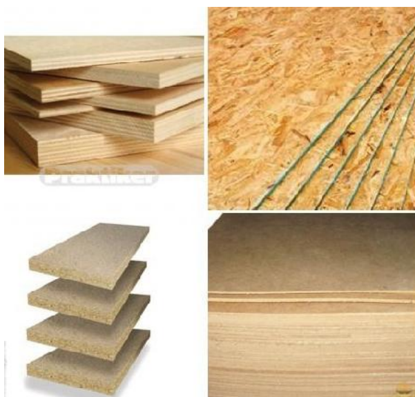
Рисунок 8.9 – Листовые материалы путем склеивания стружки
