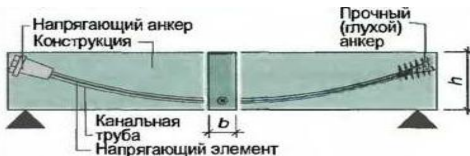
Рисунок 4.11 – Предварительное напряжение с последующей связью (на бетон)
