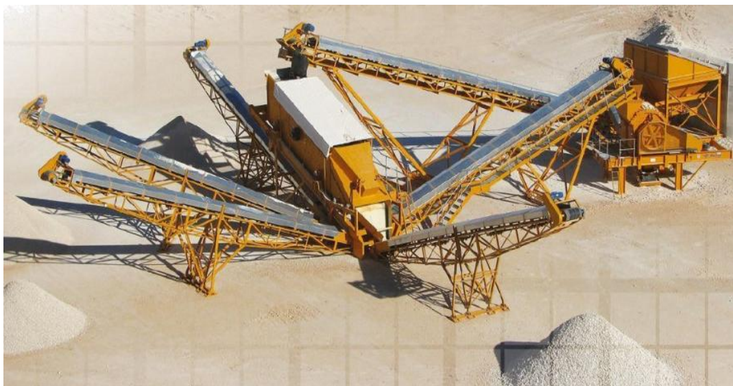
Рисунок 2.3 – Дробильно-сортировочный способ разработки камней
