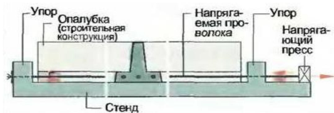
Рисунок 4.10 – Предварительное напряжение на стенде
