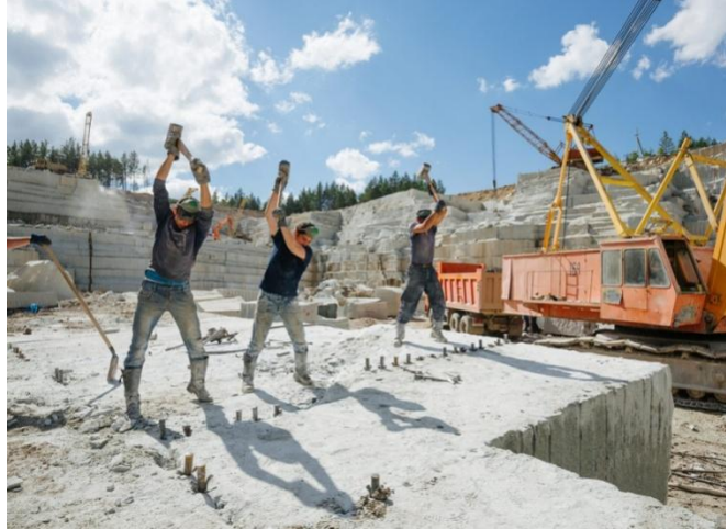
Рисунок 2.5 – Буроклиновой способ разработки твердых пород
