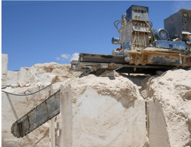
Рисунок 2.4 – Распиловка крупных блоков из пород средней твердости
