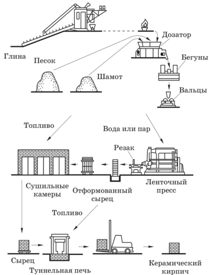
Рисунок 5.2. – Технологическая схема производства керамического кирпича
