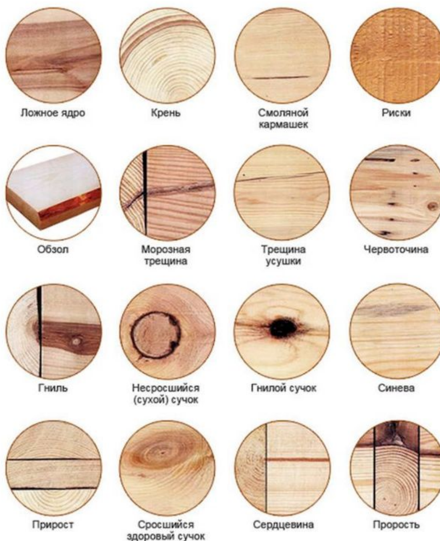
Рисунок 4.5 – Пороки древесины
