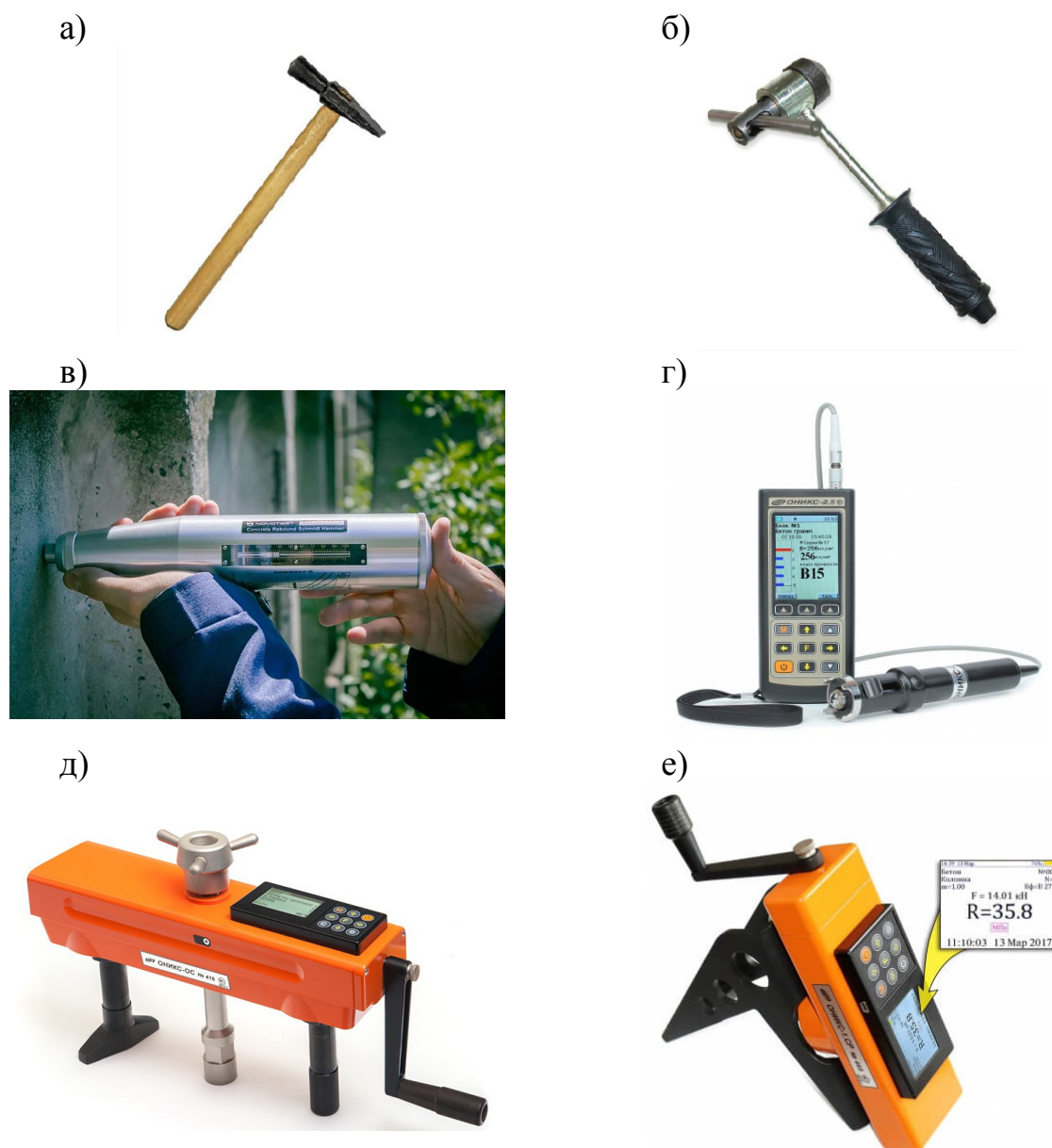
а – молоток системы И.А. Фиаздёля; б – молоток К.П. Кашкарова; в – молоток (склерометр) Шмидта; г – измеритель прочности ОНИКС-2.5; д – то же ОНИКС-ОС; е – то же ОНИКС-1.СР
