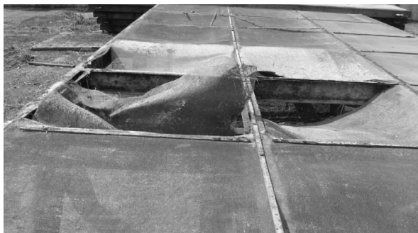
Рисунок 2.9 – Разрывы сеточного полотна РЗС ДМК Применяемая схема натяжения и крепления сеточного полотна на каркасе пре-
