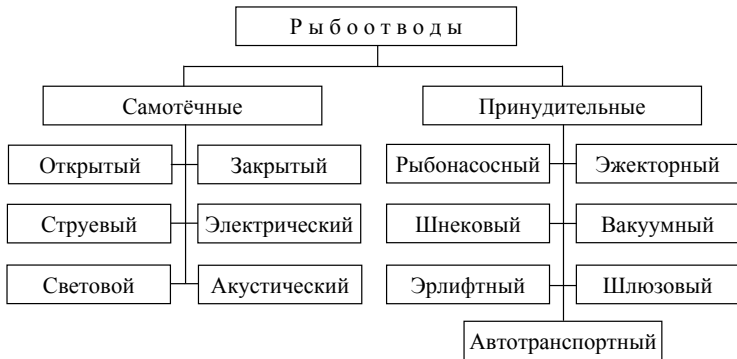
Рисунок 1.5 – Классификация рыбоотводов по способу отвода рыб
