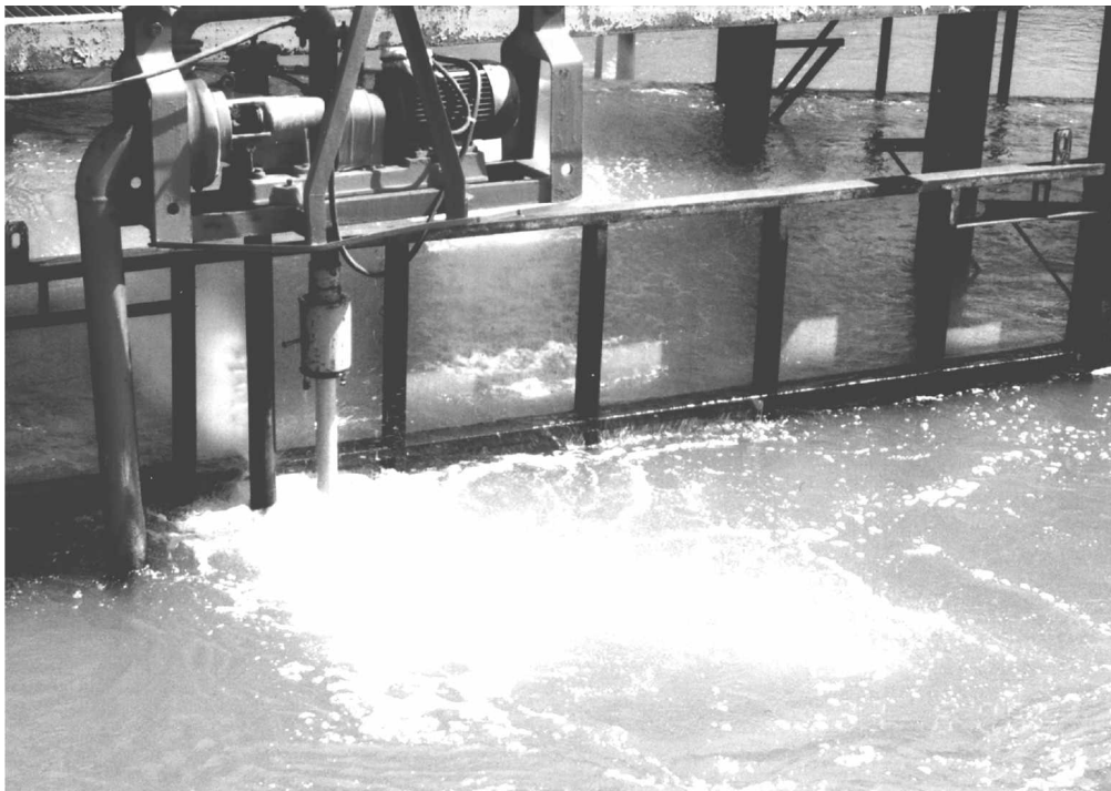
Рисунок 5.22 – Экспериментальный образец водовоздушного промывного устройства в рабочем состоянии (вид со стороны нижнего бьефа)
