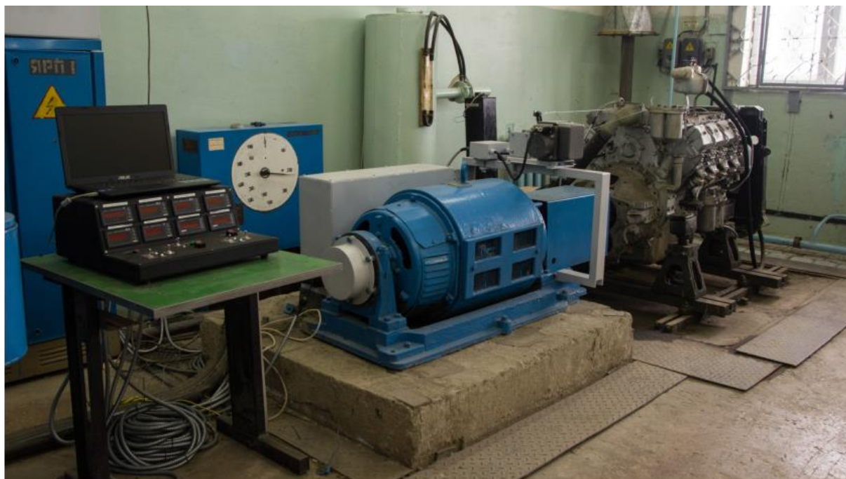
Рисунок 3.7 – Испытания двигателя внутреннего сгорания на стенде.
