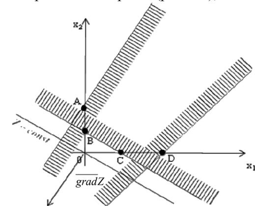
Рис. 2.9. ОДР – неограниченная выпуклая с конечным числом вершин, оптимальное решение на отрезке [BC]
