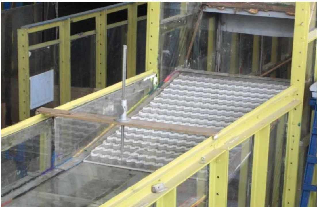
Рис. 6.5. Модель быстроготока с искусственной шероховатостью в лаборатории кафедры гидротехнических сооружений ФГОУ ВО ИМВХС имени А.Н. Костякова
