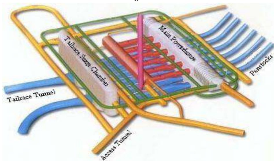
Рис. ПЗ.9. Продольный разрез (а) и трехмерное изображение (б) подземных сооружений ГЭС Дачаньшань с установленной мощностью 1,35 млн. кВт, годовая выработка энергии 5931 млн. кВт · ч.
