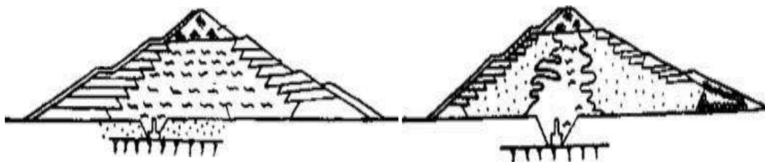
Рис. 3.14. Схемы поперечного сечения намывных плотин
