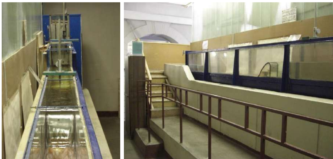
Рис. 6.3. Гидравлический лоток для исследования работы водослива практического профиля в лаборатории кафедры гидравлики ИМВХС имени А.Н. Костякова
