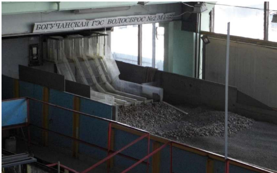
Рис. 6.4. Исследование размыва скального грунта за водосбросом на модели водосброса № 2 Богучанского гидроузла в лаборатории кафедры гидротехнических сооружений ИМВХС имени А.Н. Костякова
