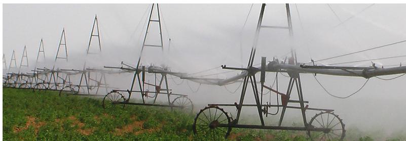
Рисунок 1.11. – Орошение с использованием ДМ «Фрегат».
