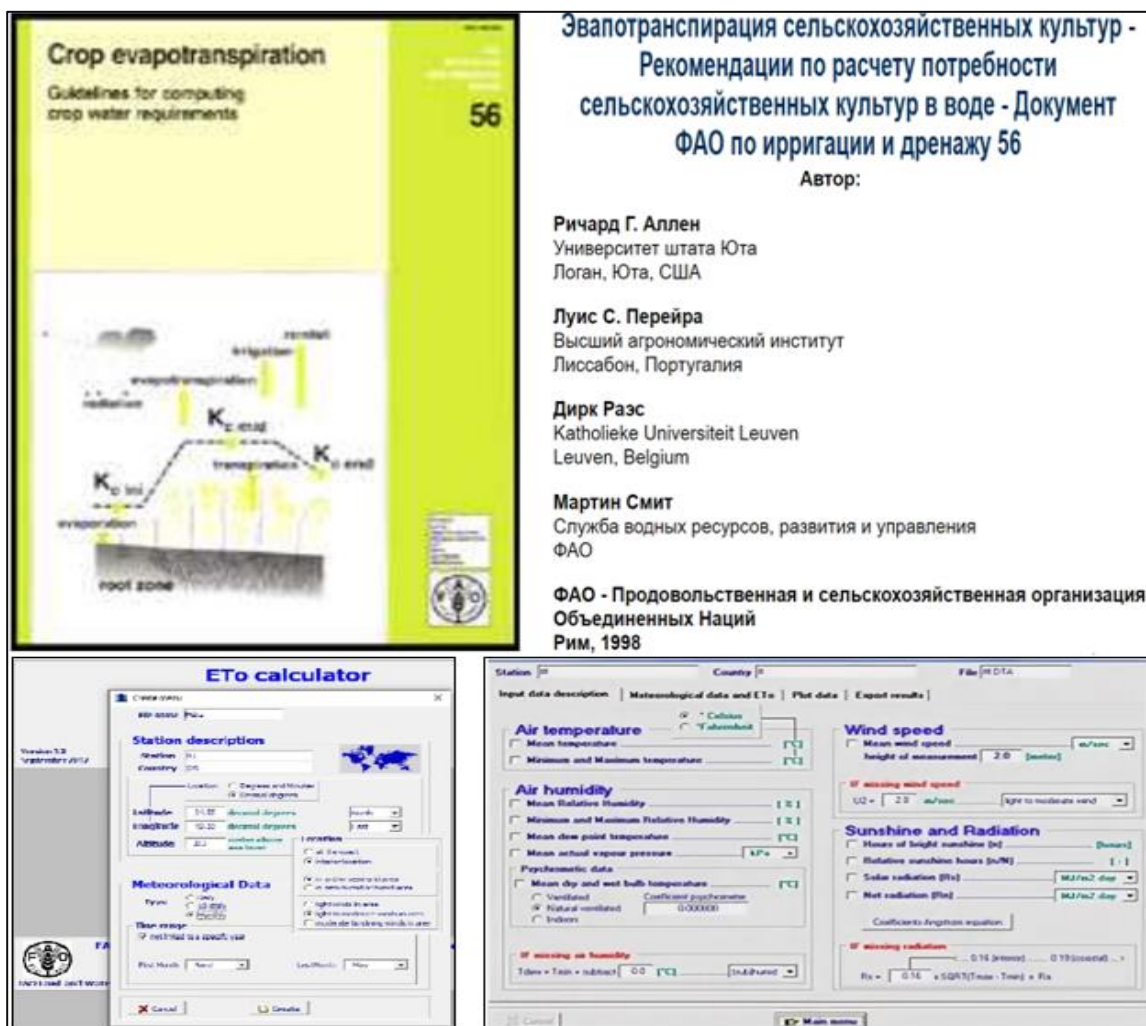
Рисунок 7.6. Методические указания и интерфейс электронного калькулятора «ETo calculator» для расчёта эвапотранспирации
