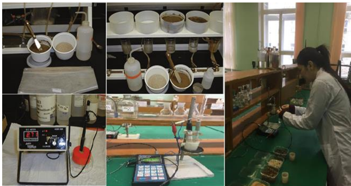
Рисунок 3.12. Подготовка насыщенной почвенной пасты по методу Ричарда
