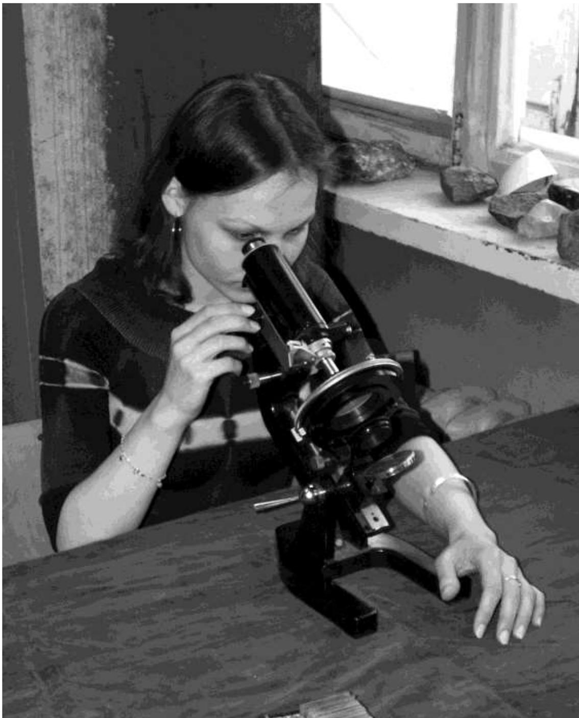
Рис. 4. Работа с поляризационным микроскопом.
