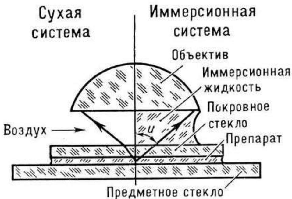
Рис 5. Определение минералов иммерсионным методом (объяснения в тексте).
