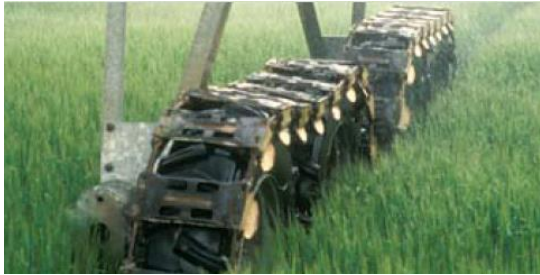
2.8 – Valmont Industries «Valley» фирмасини ёмғирлатиб суғориш машинасини занжир тасмали аравачаси
