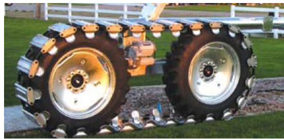
2.8 – Valmont Industries «Valley» фирмасини ёмғирлатиб суғориш машинасини занжир тасмали аравачаси
