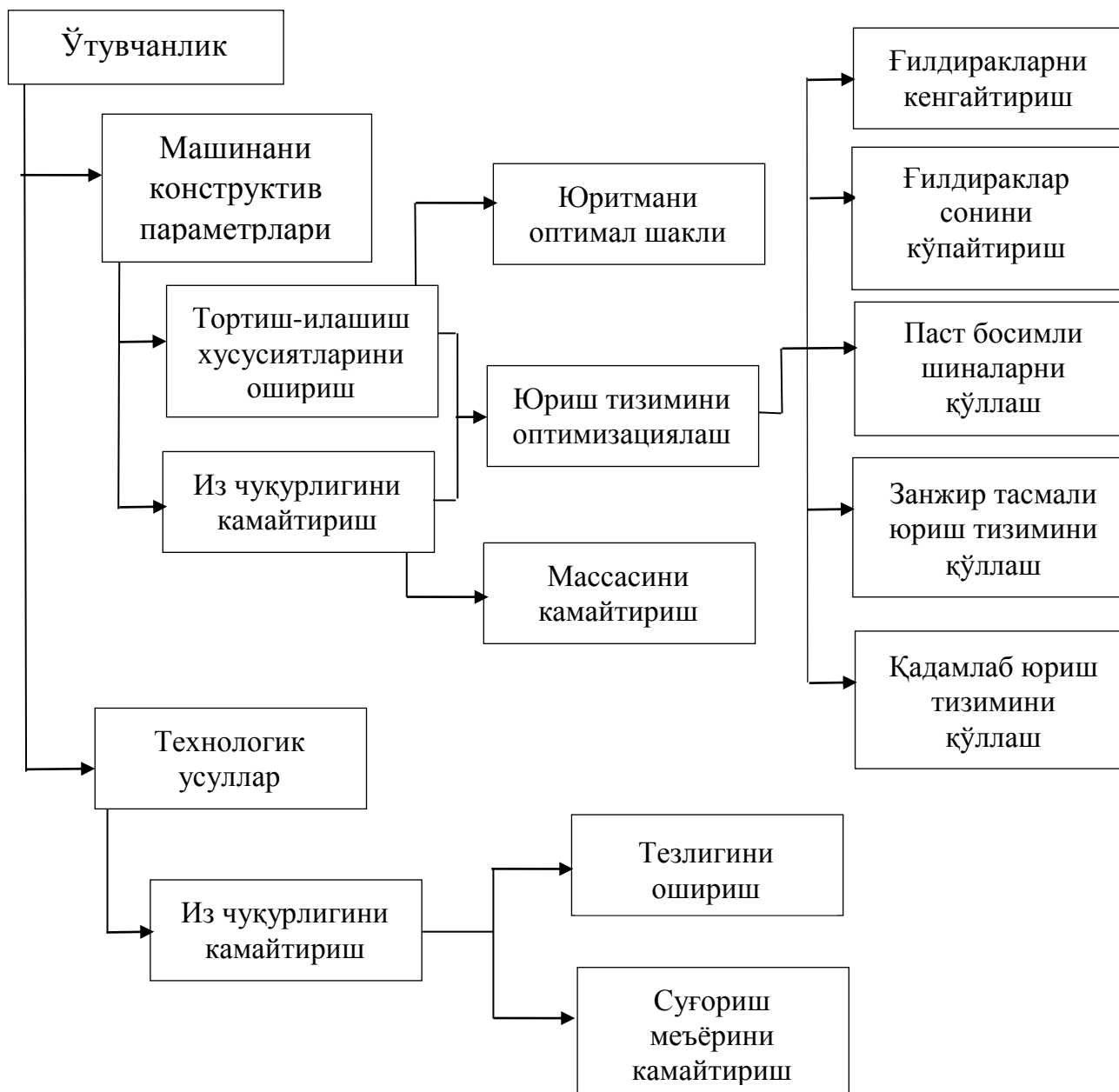
2.18 –расм. Ёмғирлатиб суғориш машиналарини ўтувчанлигини оширишни асосий йўллари
