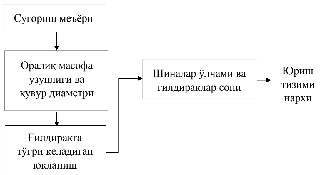
6.14 – расм. Юриш қисмини эксплуатацион сарфларини баҳолашини соддалаштирилган схемаси
