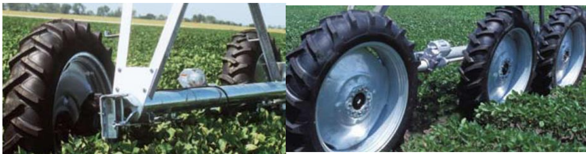
2.7 – Valmont Industries «Valley» русумли ёмғирлатиб суғориш машинани 2 ва 3 ғилдиракли тизимлари
