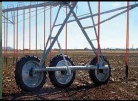
2.9 – расм. Lindsay Manufacturing фирмасини ботқоқликда ҳаракатланишга мослаштирилган юриш тизими
