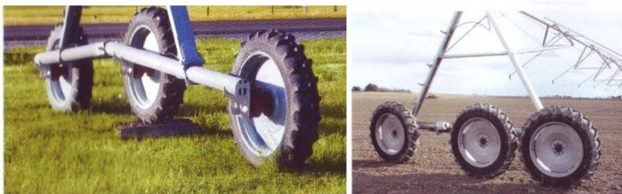
2.12 – расм. Reinke фирмаси ишлаб чиқарадиган ёмғирлатиб суғориш машиналарининг уч ғилдиракли юриш тизими
