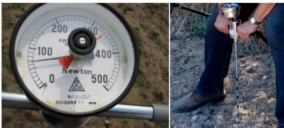
4.3 – Учликни тупроқға ботишини пенетрацияси
