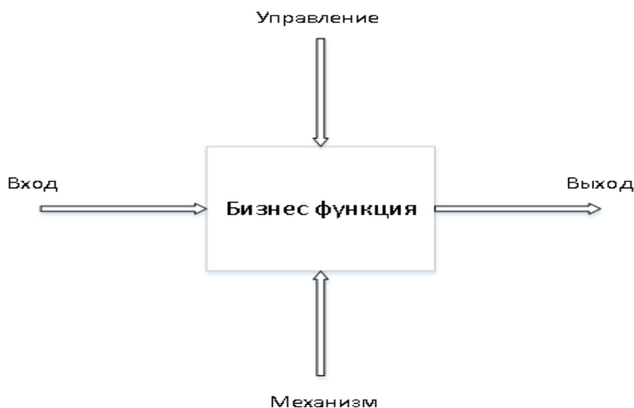
Рисунок 6 – Строение функционального блока
