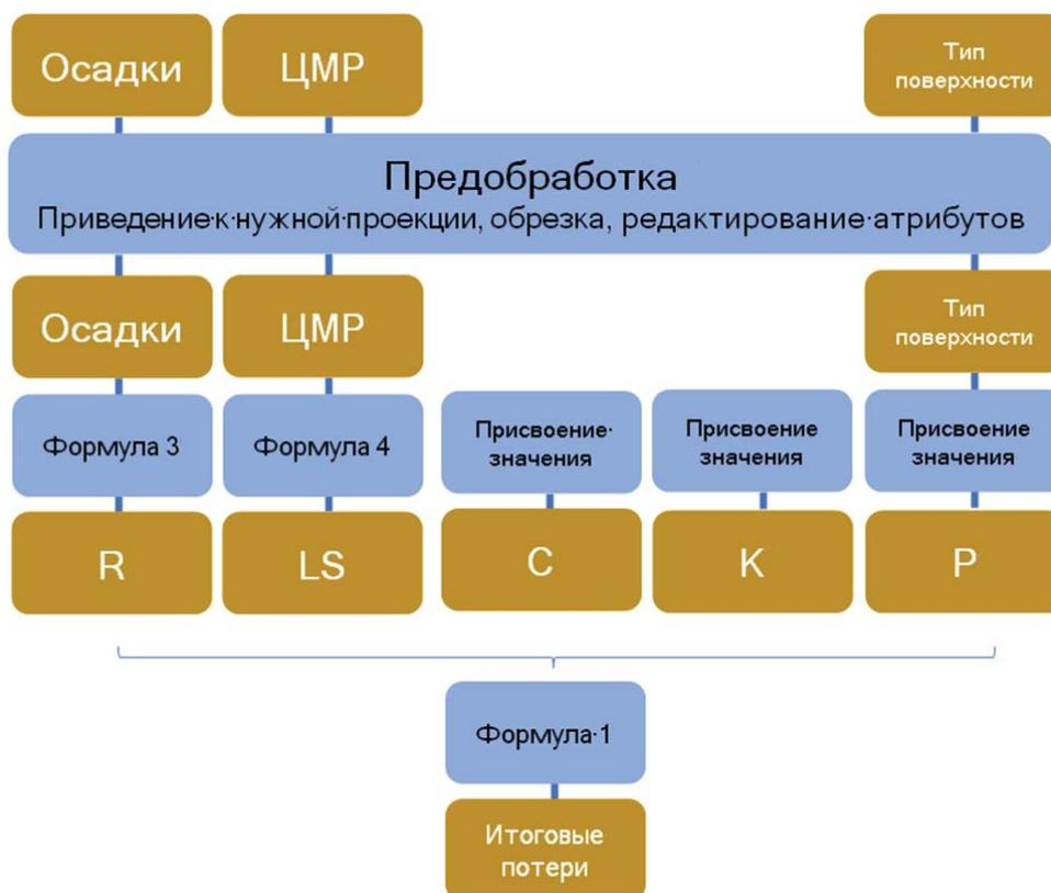
Рисунок 112. Общая блок-схема расчетов потерь вследствие эрозии по методу RUSLE с использованием дистанционных данных
