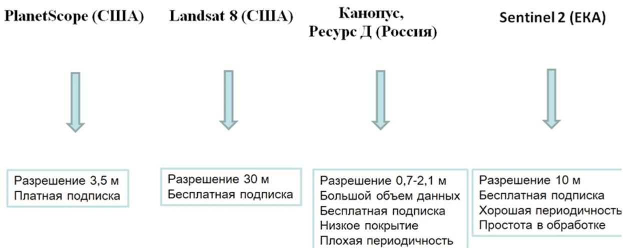
Рисунок 1. Обзор наиболее распространенных спутников и условия получения их данных
