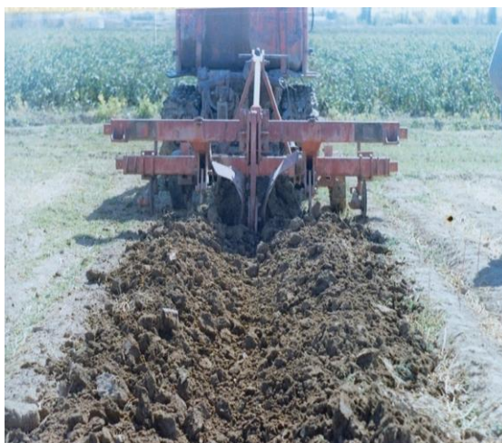
Рис.1. Вспашка плугом с фронтальными корпусами расположенными по листерной схеме без заплужников обеспечивающая формирование поливной борозды
