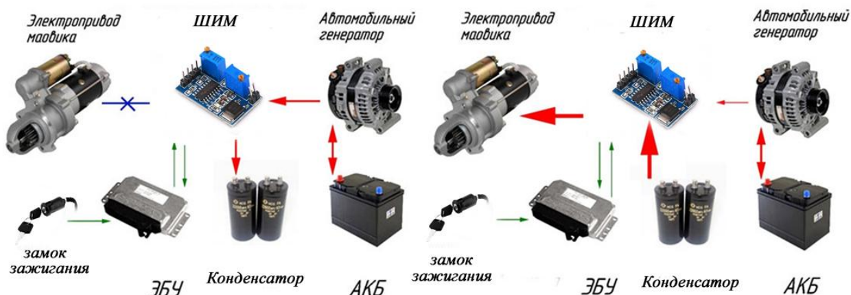
Рис. 2. Общая схема электрического запуска ДВС от конденсаторов с ШИМ управлением
