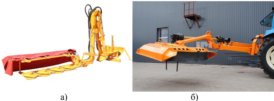
Рис.1. Косилки навесные с изменяющимся положением в пространстве: а) косилка-кусторез роторная навесная К-78М; б) косилка цепная SAME M 1650
