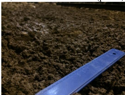
Рис.1. Изменённое состояние поверхностного слоя почвы после прохода катка
