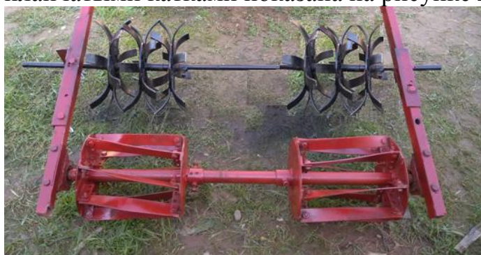
Рис. 2. Рыхлительно-выравнивающее устройство для полосовой предпосевной обработки почвы в зоне посева бахчевых культур
