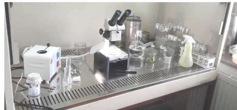
Рис. 25. Ламинарный бокс, оборудованный бинокулярной лупой для выделения апикальных меристем
