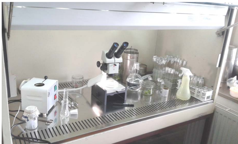
Рис. 7. Ламинарный бокс, оборудованный бинокулярной лупой для выделения апикальных меристем
