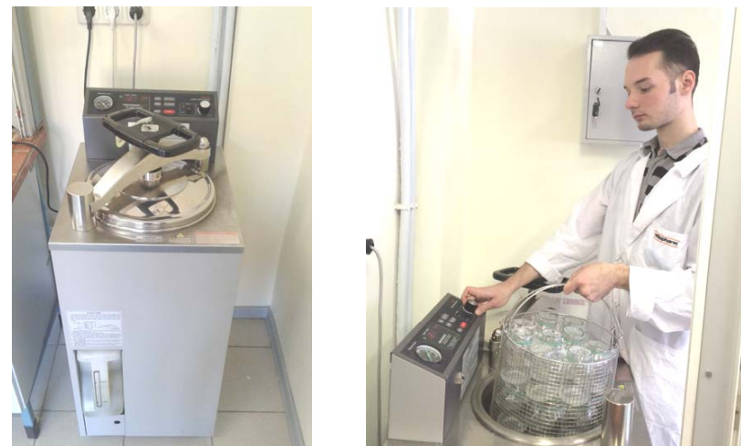
Рис. 4. Общий вид автоклава и процесс разгрузки стерилизационной камеры
