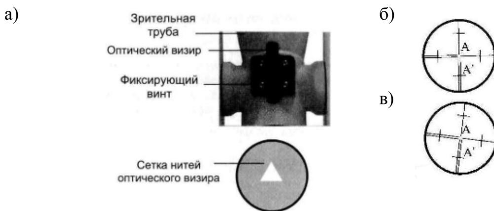
а – зрительной трубы, оптического визира, вид сетки нитей оптического визира;
