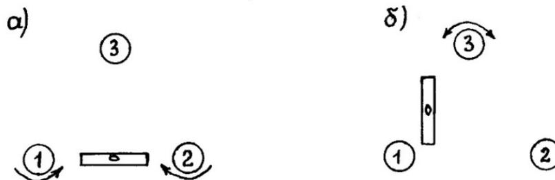
Рисунок 10 – Порядок горизонтирования теодолита
