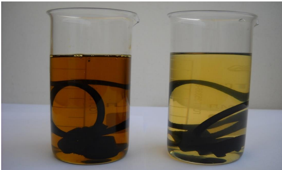
Рисунок 3.10 – Резинотехнические изделия фильтров: 1 – в рапсовом масле; 2 – в товарном дизельном топливе
