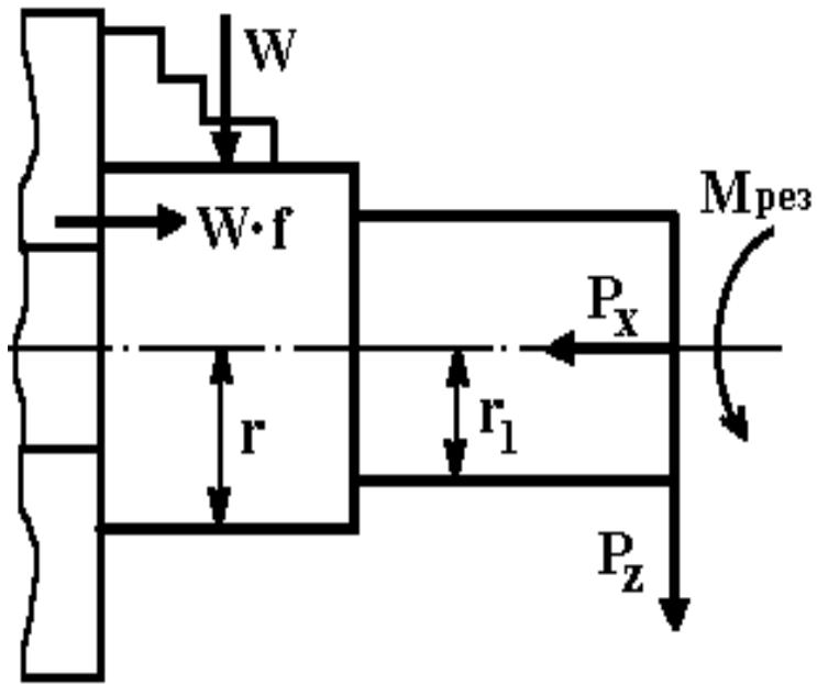
Рис. 6.9. Силы действующие на трехкулачковый патрон станка.
