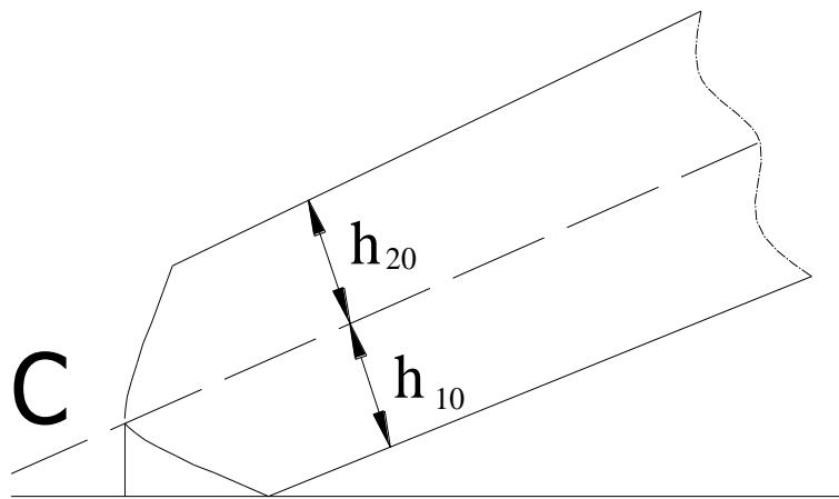
Рис. 3.26. Параметры слоев однородного стабилизированного лезвия
