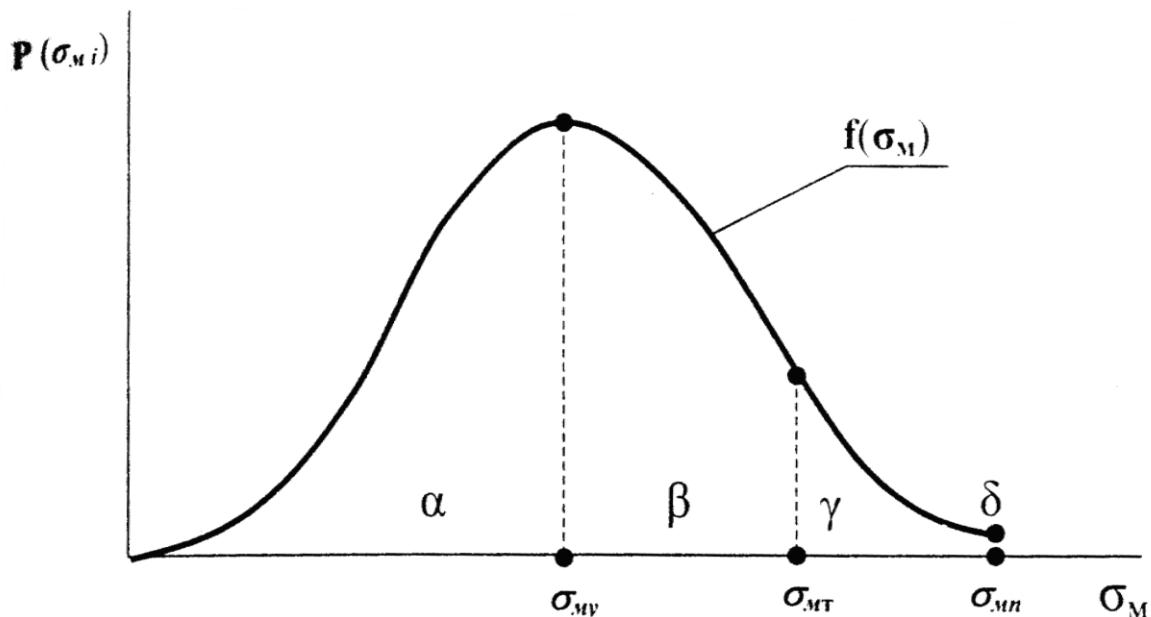
Рис. 3.1. Дифференциальная функция плотности вероятности контактных напряжений в материале
