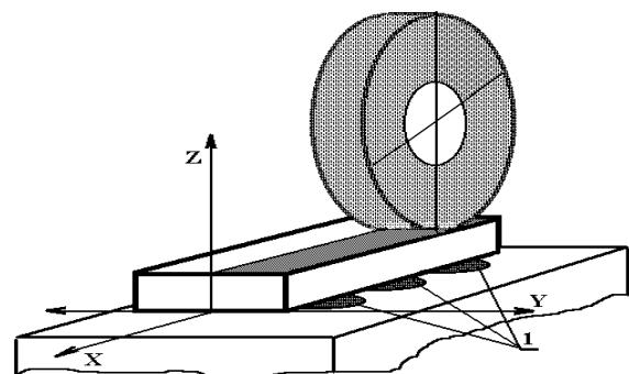
Рис. 4.16. Закрепление на столе станка
