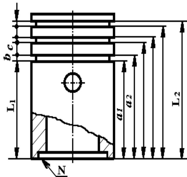
Рис. 4.20. Простановка размеров ширины канавок под поршневые кольца методом "цепочки".
