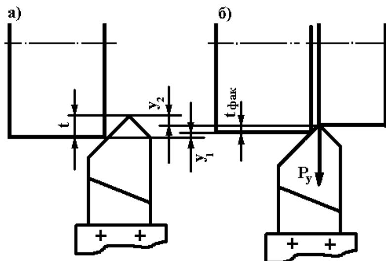
Рис. 5.3. Схема отжатий элементов технологической системы.
