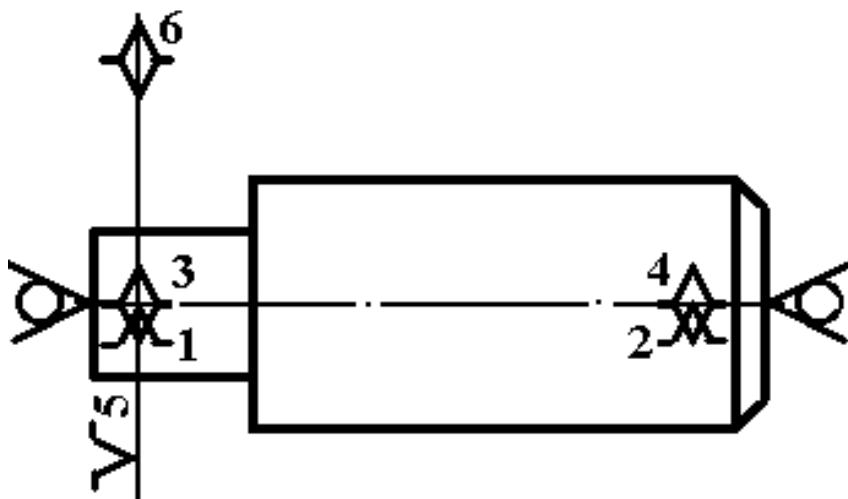
Рис. 4.19. Теоретическая схема базирования валика при обработке его в центрах и поводковом патроне.
