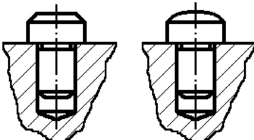
Рис. 4.14. Пример специальных опор для установки заготовки.
