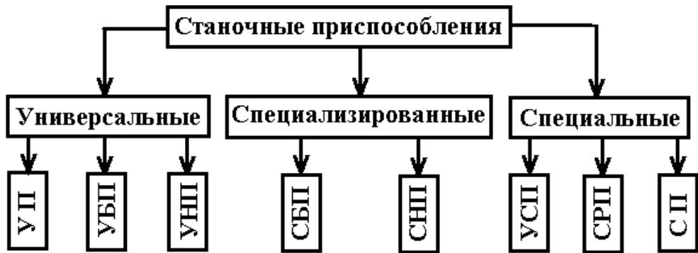
Рис. 6.1. Станочные приспособления.
