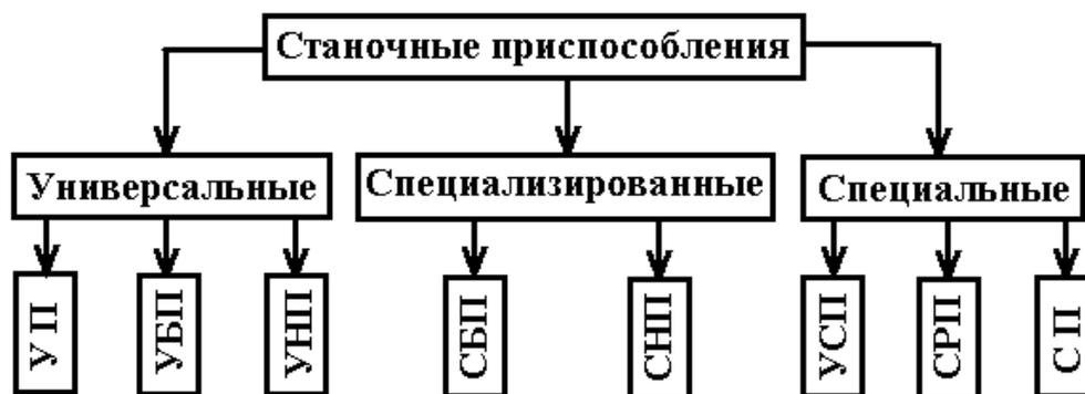
Рис. 6.1. Станочные приспособления.
