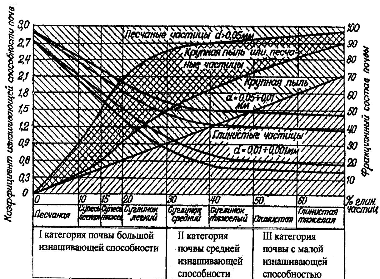
Рис. 3.30. Классификация почв по их изнашивающей способности
