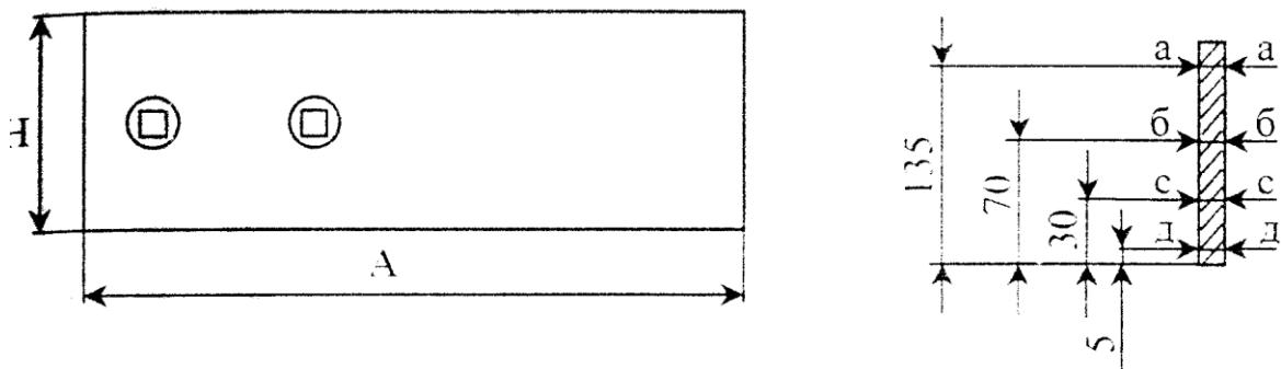
Рис. 3.7. Контролируемые параметры полевой доски
