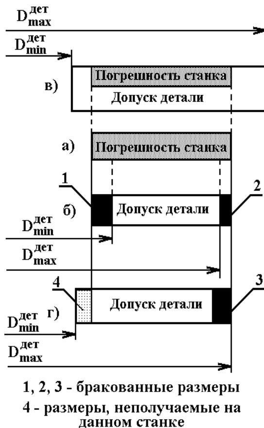
Рис. 5.1. Определение предельных размеров системы СПИД, погрешности станка.
