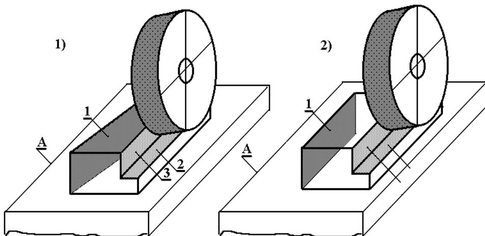
Рис. 4.12. Установка заготовки на магнитный стол
