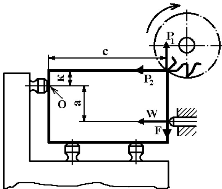
Рис. 6.10. Силы действующие на трехкулачковый патрон станка.
