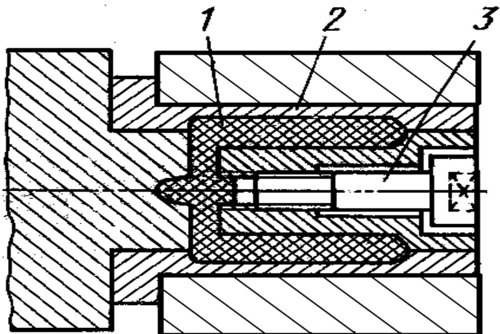
Рис. 6.7. Оправка с упругой гильзой.
