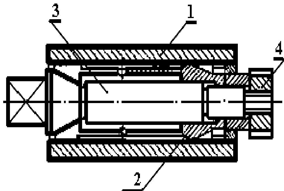
Рис. 6.8. Разжимная цанговая оправка.
