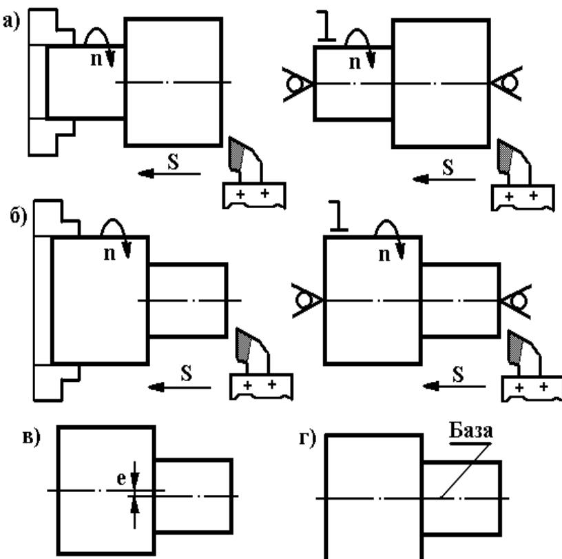
Рис 4.13. Точение шеек вала за две установки в 3-х кулачковом патроне.
