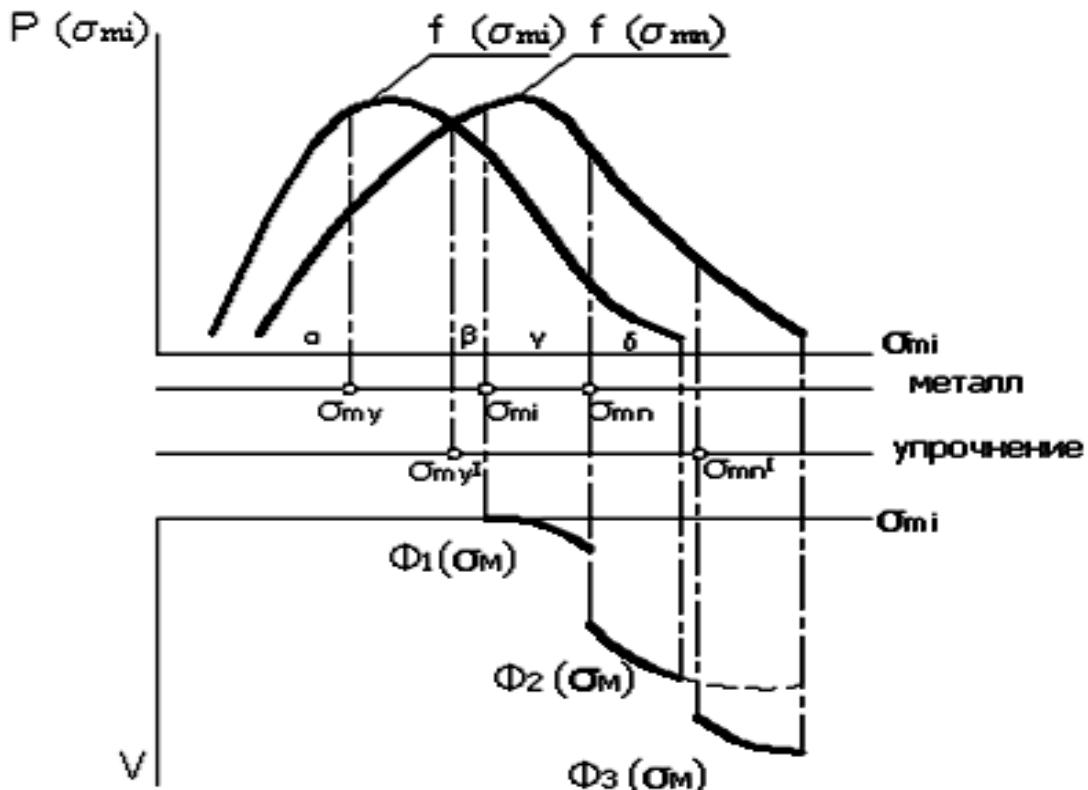
Рис. 3.3. Дифференциальные функции плотности вероятностей контактных напряжений
