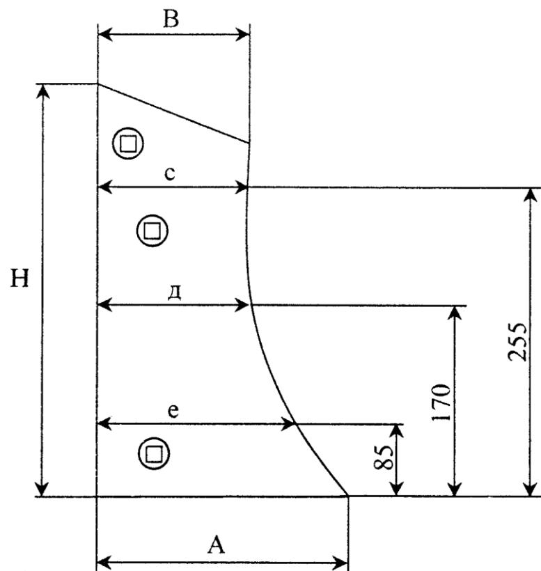
Рис. 3.8. Контролируемые параметры груди отвала
