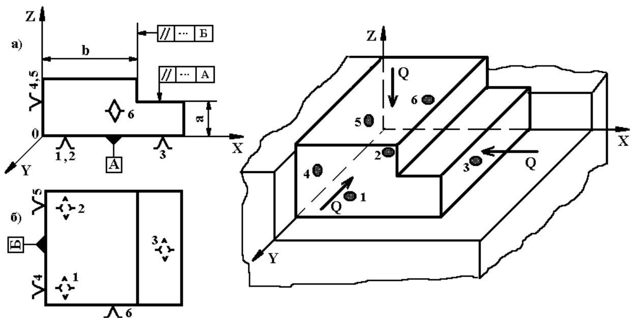
Рис. 4.18. Теоретическая схема базирования заготовки с помощью установочной, направляющей и опорной баз
