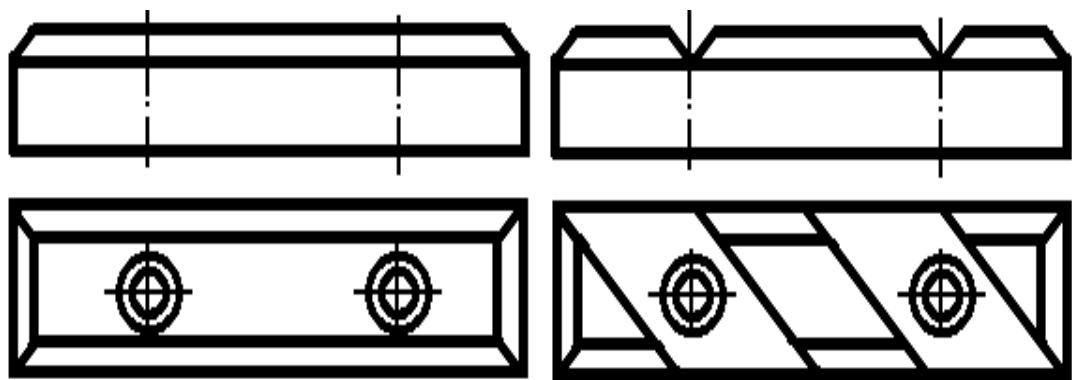
Рис. 6.4. Неподвижные опорные пластины.
