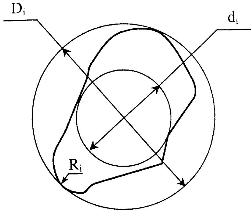
Рис. 3.2. Схема абразивной частицы
