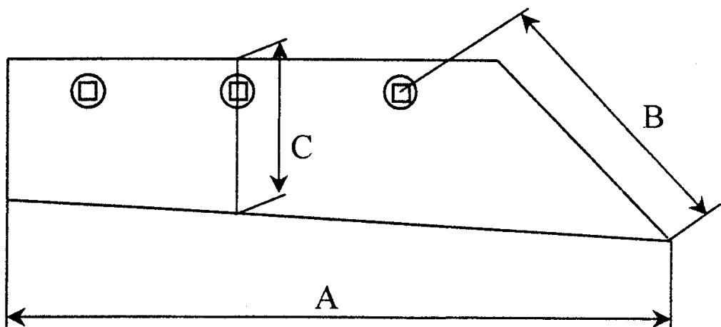
Рис. 3.6. Контролируемые размеры лемеха
