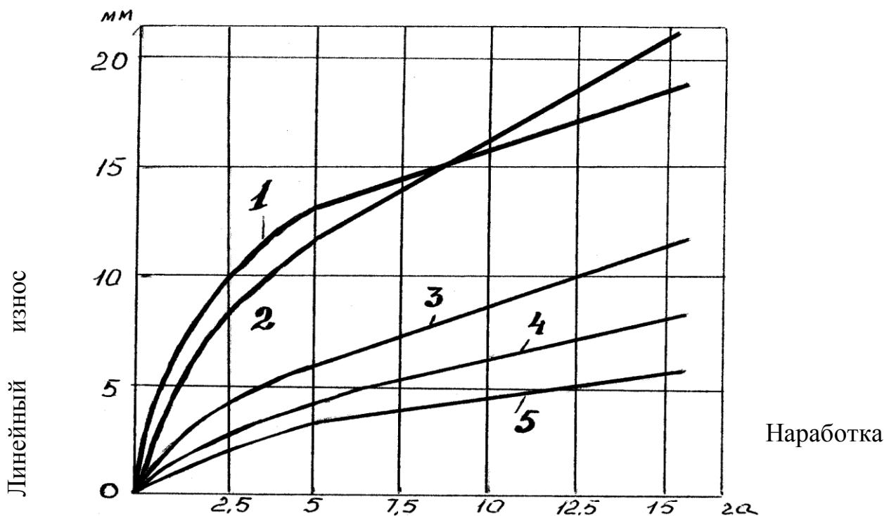
Рис. 3.29. Изменение интенсивности линейного износа лемеха при работе на различных почвах:
