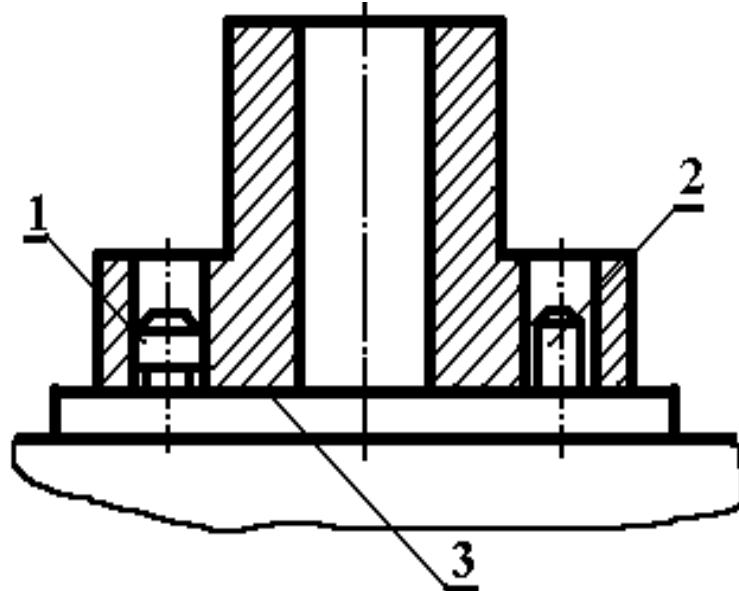
Рис. 6.6. базирование корпусных деталей.
