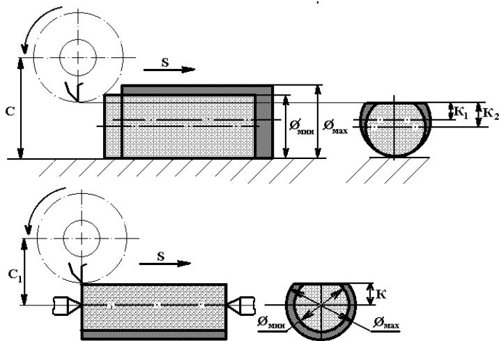
Рис. 4.21. Операция фрезерования лыски на валу с установкой вала на столе станка и в центрах
