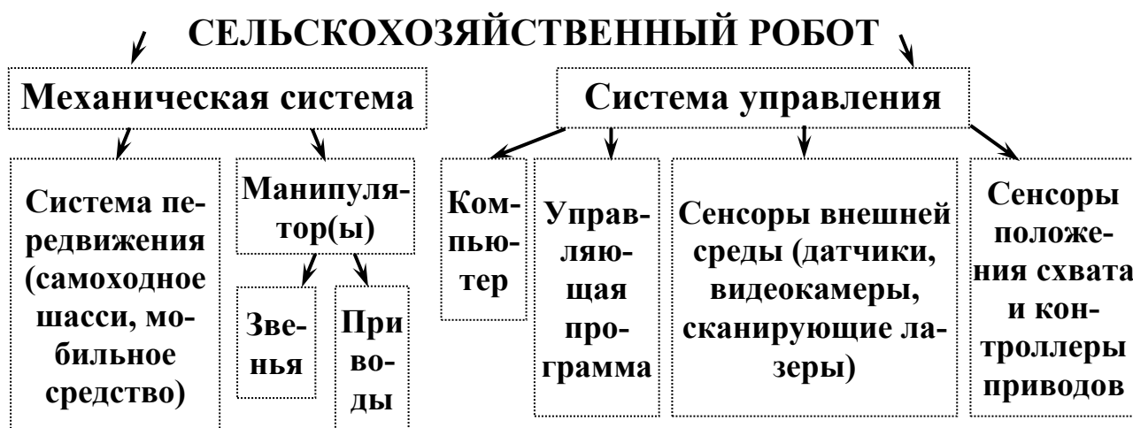
Рис. 9.5. Системные элементы сельскохозяйственного робота
