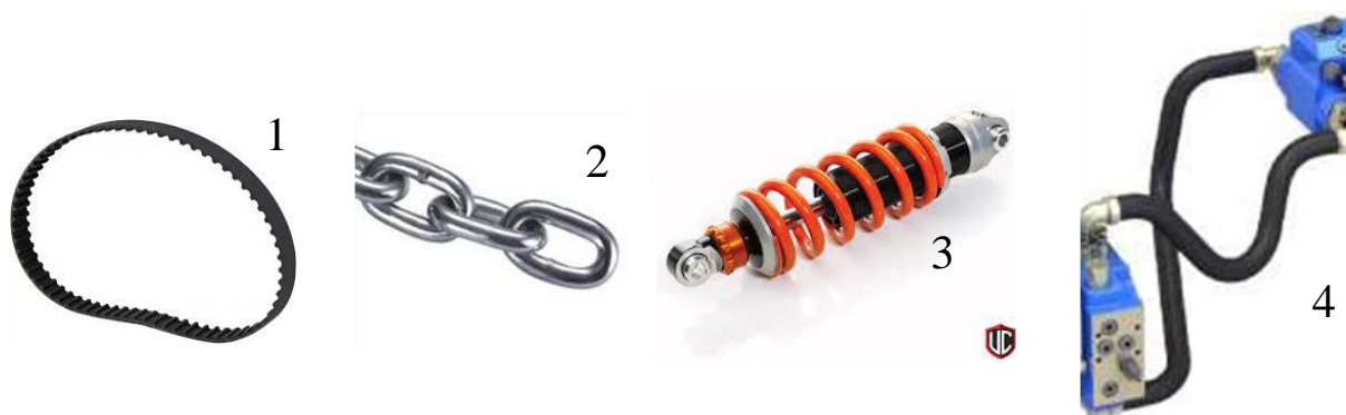
Рис. 1.2. Динамические элементы механизма: ремень 1, цепь 2, пружина 3, жидкость в шланге 4
