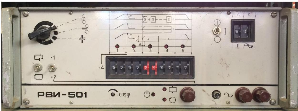
Рис. 8. Регулятор циклов сварки РВИ-501
