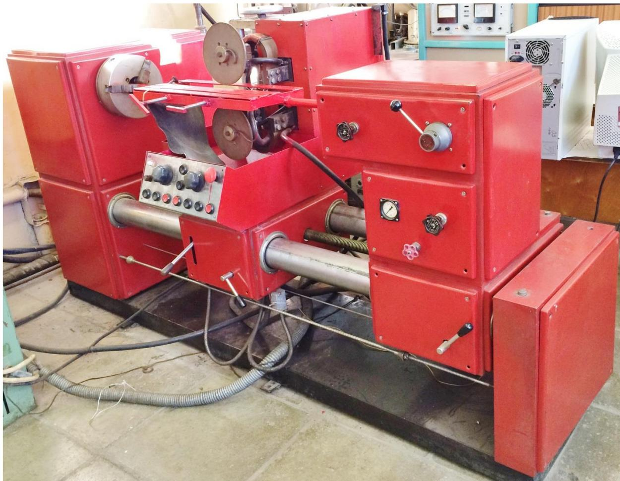
**Рис. 6. Установка для электроконтактной приварки 011-1-10**
