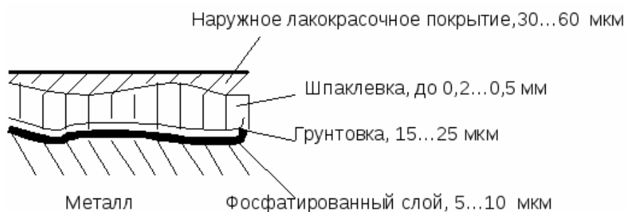
Рис. 1. Структура ЛКП сельскохоззяйственной техники
