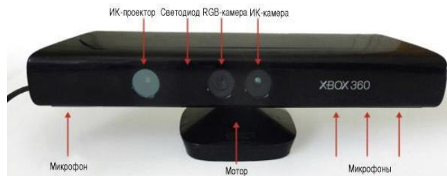
Рис. 1. Устройство контроллера Kinect
