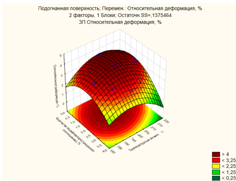
Рис. 2. Поверхность отклика относительной деформации
