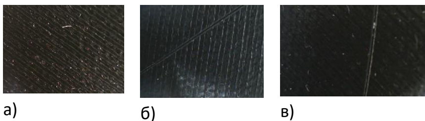
Рис. 5. Фото поверхности образца №5: а - до антиадгезионных испытаний, б – после, в - после выдержки в воде 90 дней
