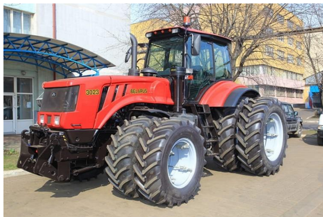
Рис.3. Трактор МТЗ-3023 с электромеханической трансмиссией
