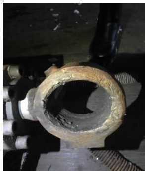
Рис. 6. Абразивный износ шарнирного соединения
