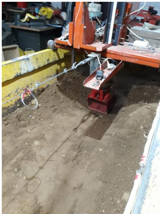
Рис. 2. Исследование модели рабочего органа в грунтовом канале.
