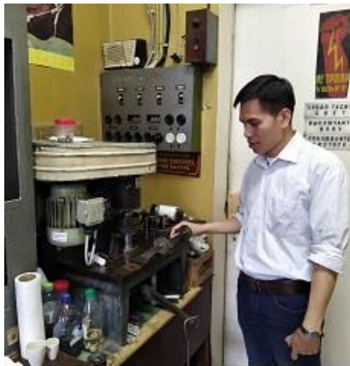
Рис. 3. Определение противоизносных свойств смазочного материала Результаты испытаний показаны на и рис. 4.
