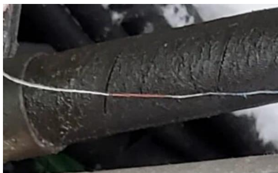
Рис. 5. Микротрещины в РВД
