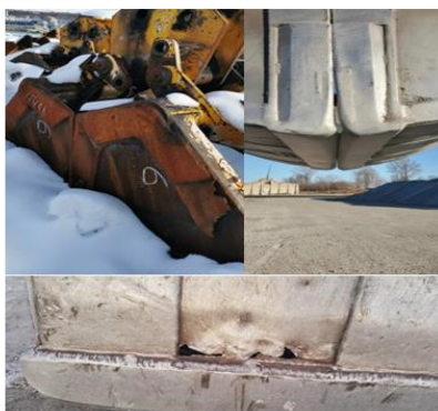
Рис. 2. Износ стенки и обечайки грейфера
