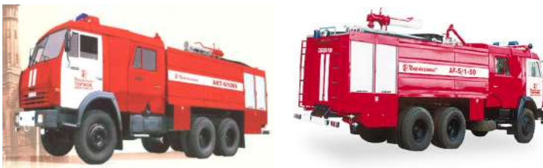
Рисунок 25.1 - Автомобили комбинированного тушения: слева - АКТ 6/1000-80/20(53229)ПМ-570, справа – АФ-5/1-60
