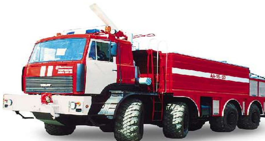
Рисунок 23.2 - Пожарный аэродромный автомобиль AA-15/80-100/3 (790912) ПМ-539
