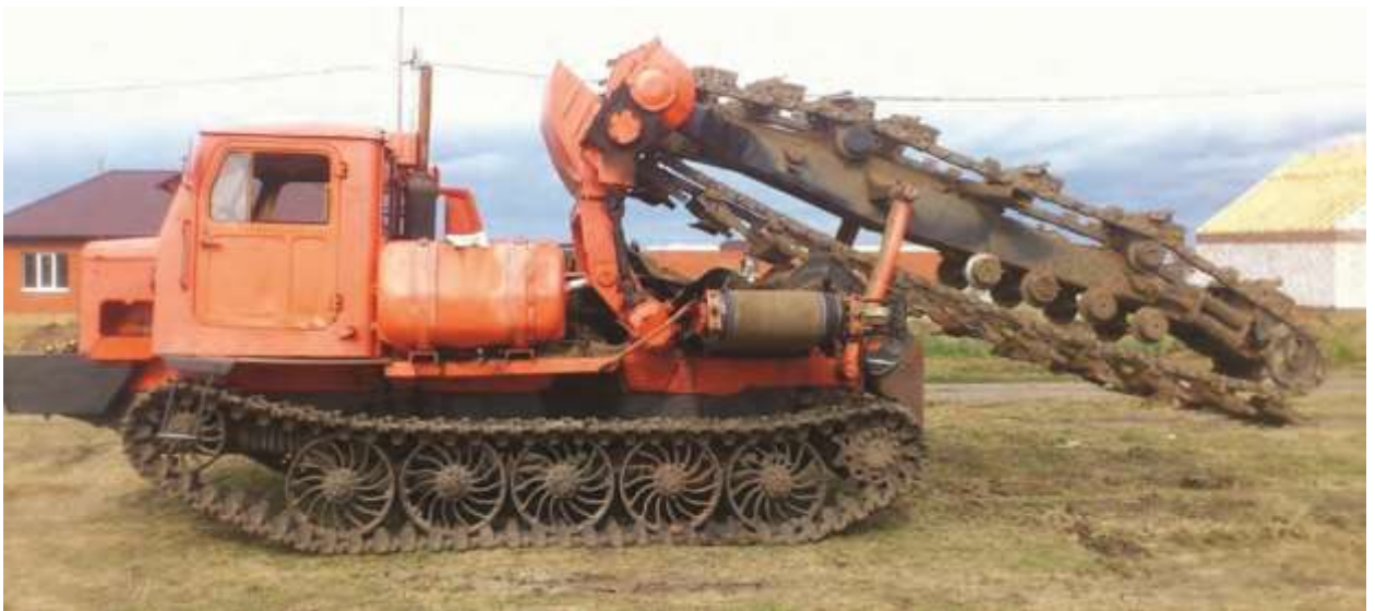
Рисунок 5.8- Экскаватор непрерывного действия цепной
