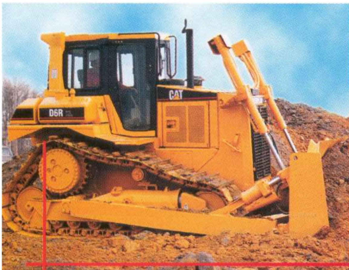
Рисунок 6.1 –Бульдозер с гусеничным ходовым оборудованием
