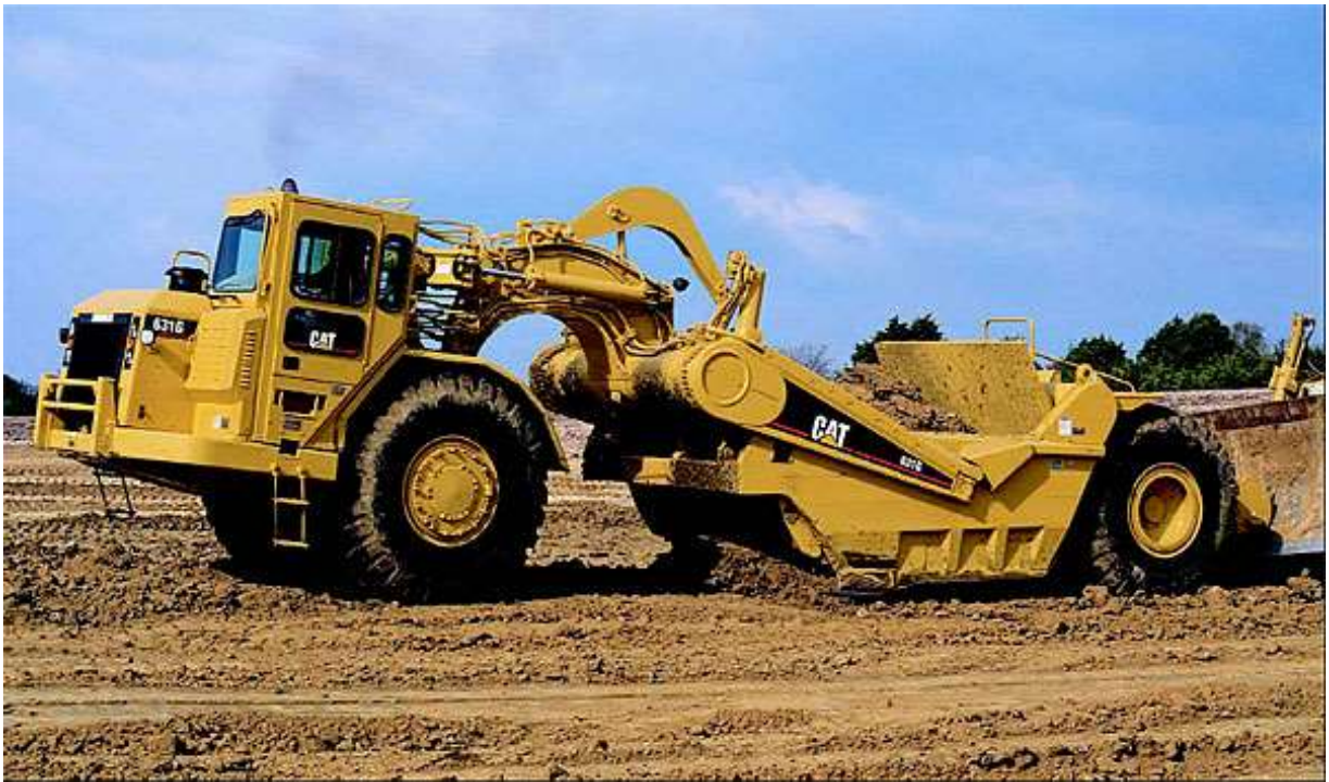
Рисунок 6.6 –Набор грунта скрепером
