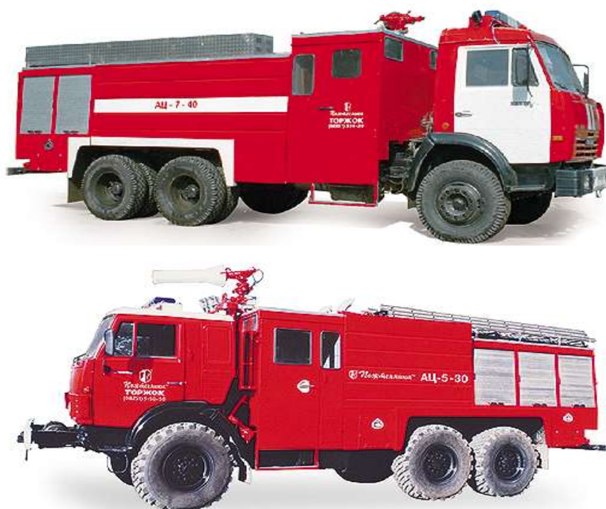
Рисунок 18.5- Пожарные автоцистерны моделей ПМ-524 и ПМ-525
