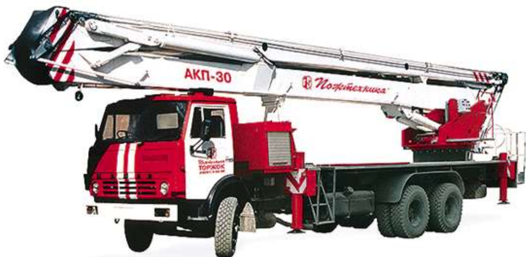
Рисунок 29. 5 - Пожарный коленчатый автоподъёмник АКП-30(53213)ПМ-509Б
