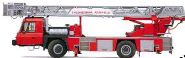
Рисунок 29.1 пожарные автолестницы с высотой подъёма 30 метров: а) АЛ-30(5337)ПМ-506Д; б) АЛ-30(53211)ПМ-512Б; в) АЛ-31(433112)ПМ-559; г) АЛ-30(Татра Т-815)
