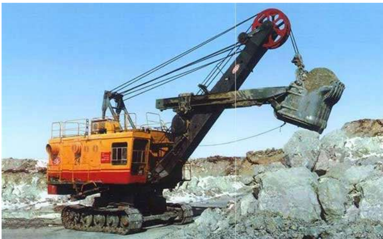
Рисунок 5.1- Одноковшовый экскаватор с прямой лопатой, канатно-блочной системой управления
