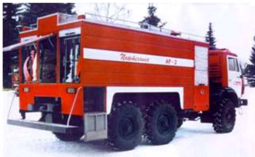
Рисунок 19.3 - Пожарные рукавные автомобили АР-2 на шасси КамАЗ-43114: модель 215; модель ПМ-538 (внизу)
