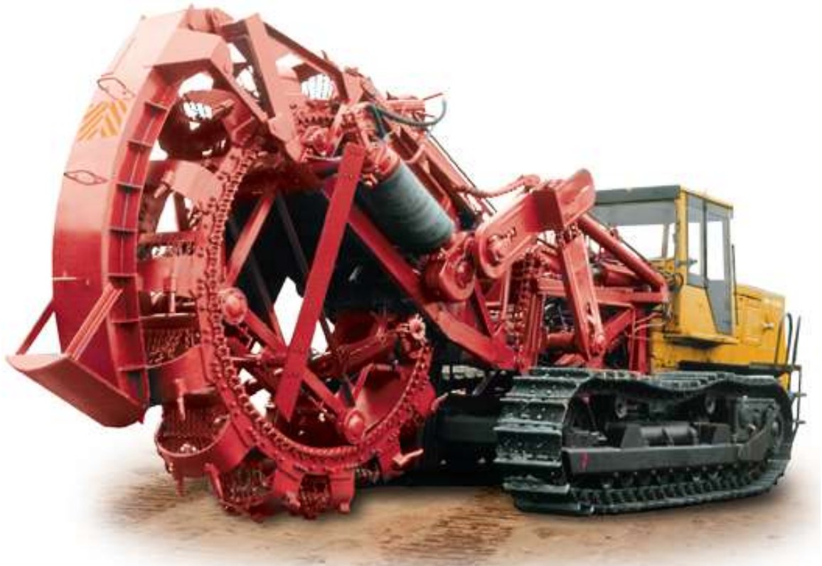
Рисунок 5.7- Экскаватор непрерывного действия с ковшовым рабочим оборудованием
