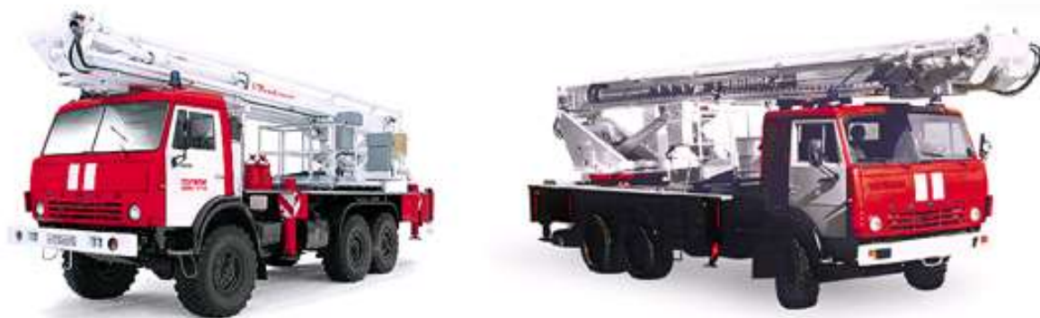
Рисунок 29.6 - Пожарные автоподъёмники АКП-32(43118)ПМ-545 (слева) и АКП-35(53213)ПМ-545 (справа)
