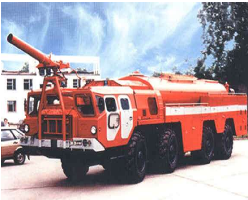
Рисунок 23.1 Пожарный аэродромный автомобиль АА 60(7310)160.01
