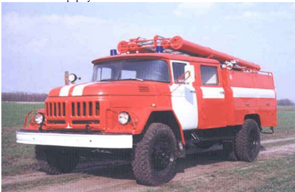
Рисунок 18.1 - Пожарная автоцистерна АЦ-40(431410)63Б
