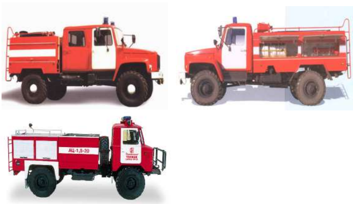
Рисунок 27.2 - Пожарные лесопатрульные автомобили АЦ(Л): АЦ-1,0-30(3308)4ВР (вверху слева), его вариант АЦ-1,6-30(3308) (вверху справа), АЦ-1,6-20(66)ПМ-571 (внизу слева)
