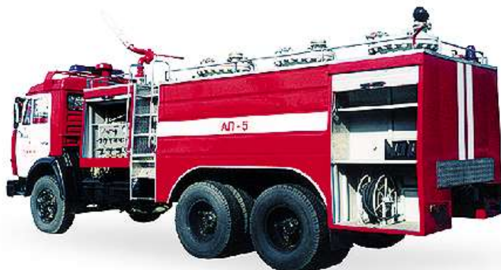
Рисунок 22.2 - Автомобиль порошкового тушения АП-5000-50(53215)ПМ-567А
