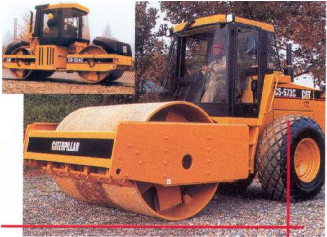
Рисунок 6.9 –Каток статического действия
