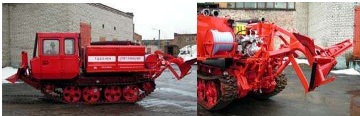
Рисунок 27.3 - Лесопожарный трактор ТЦ-2,5-40/4(ТЛТ-100А)ВЛ
