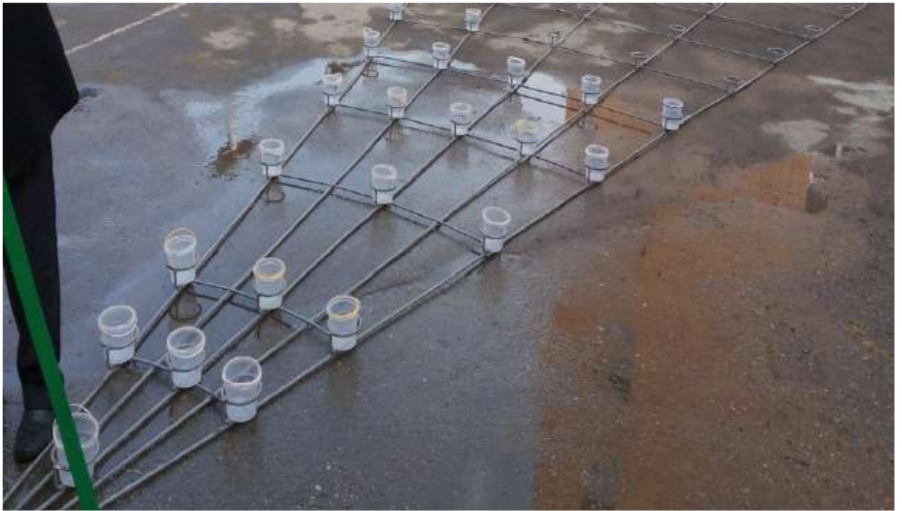
Рисунок. 3.5 – Расстановка дождемеров при лабораторных исследованиях
