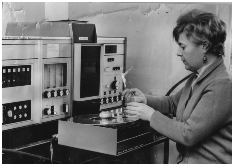
Старший научный сотрудник Е. П. Полякова осваивает методику атомно-абсорбционной спектрофотометрии на приборе Pye-Unicam SP-1900. 1976 год
