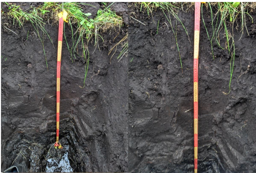
Рисунок 4.8 – Шурф почвенного профиля, открытый на участке исследований: 0...20 см – дерновый слой, очес, A_0 ; 20...65 см – черный торф с единичными корнями растений, T_1 ; 65...100 см – черный с коричневым оттенком торф, T_2
