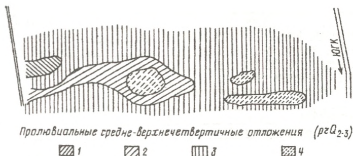
Рис. 3.6 Геолого-литологическое строение Голодностепского опытно-производственного участка: 1 – тяжелые суглинки; 2 – средние суглинки; 3 – средние пылеватые суглинки; 4 – легкие суглинки.
