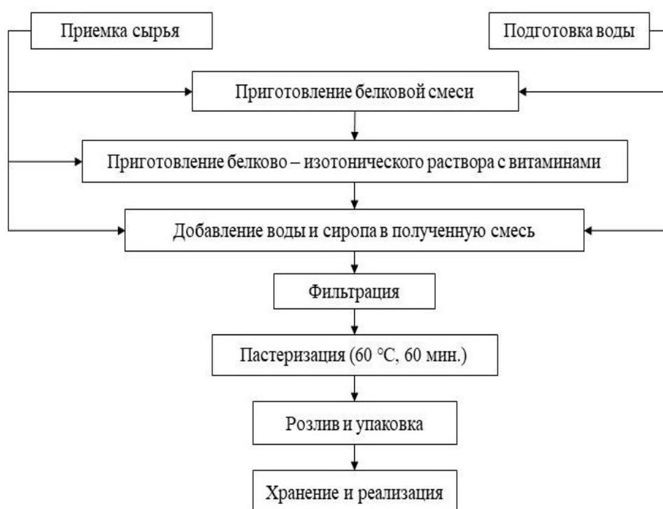
Рисунок 1 – Технологическая схема производства изотонического напитка, обогащенного изолятом сывороточного белка и витаминным премиксом
