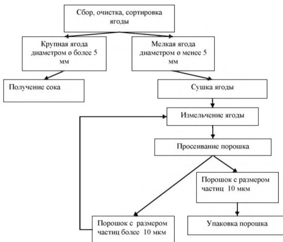
Рисунок 1 – Технологическая схема получения брусничного порошка
