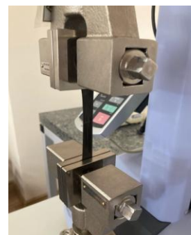
Рис. 2. Результаты физико-механических испытаний образцов полиэтиленовых пакетов, модифицированных оксо-добавкой d2W.
