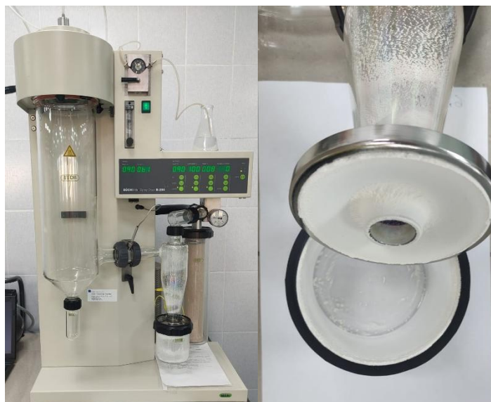
Рис. 1. Процесс распылительного высушивания сухого экстракта корневой культуры женьшеня настоящего ( Panax ginseng )
