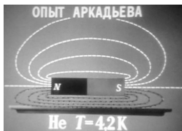
Рис. 4.9. Опыт В.К. Аркадьева с «висящим магнитом»
