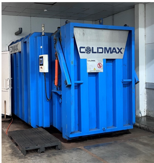
Рис. 37. Камера охлаждения плодовых тел шампиньона
