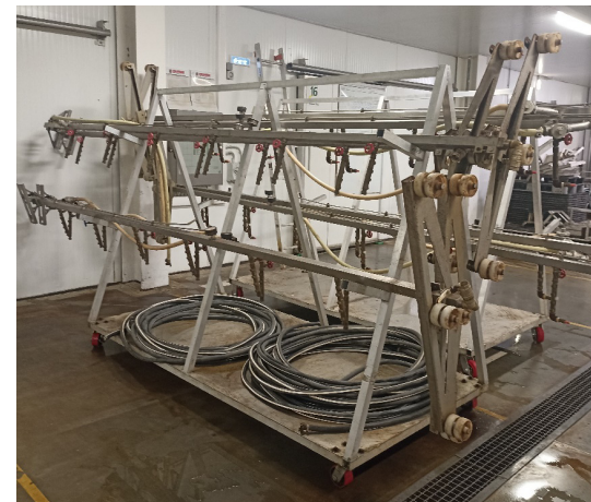
Рис. 32. Установка «дерево» для мелкодисперсного полива компоста в фазу активного роста мицелия
