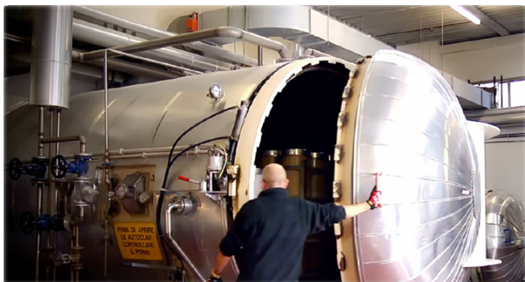
Рис. 40. Проходной автоклав для стерилизации носителя
