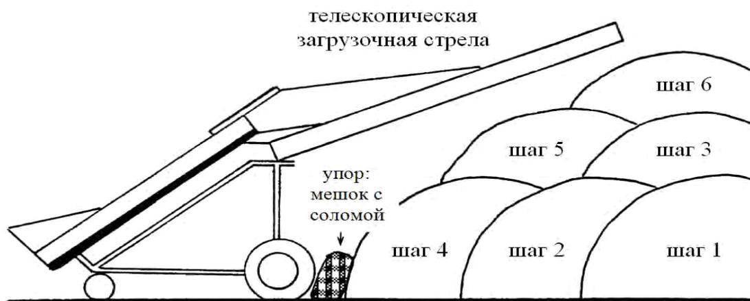
**Рис. 5. Последовательность формирования насыпи при помощи транспортёра загрузчика с телескопической стрелой**
