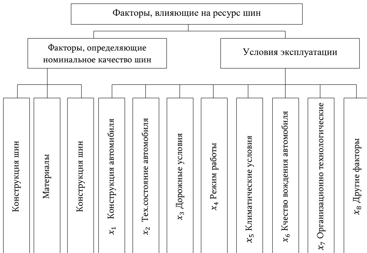
Рисунок 1.2 – Классификация факторов, влияющих на ресурс шин [8]
