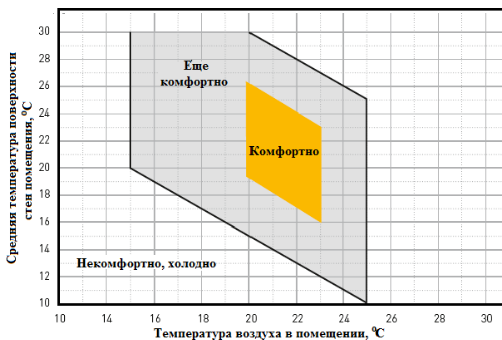
Рис. 4.14. Температурный комфорт при сидячей работе, средней активности и соответствующей одежде в виде функции средней температуры поверхности стен помещения и температуры воздуха в помещении
