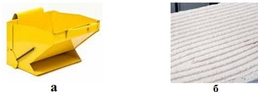
Рис. 3.67. Нанесение клеящего слоя: а — каретка для нанесения раствора; б — равномерное нанесение раствора
