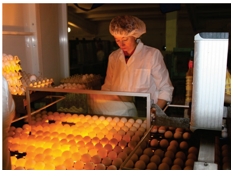
Рисунок 3 – Овоскопия яиц (с сайта http://www.ak-oredej.ru/tehnologiya_proizvodstva/sortirovka_i_upakovka_yaic/ )
