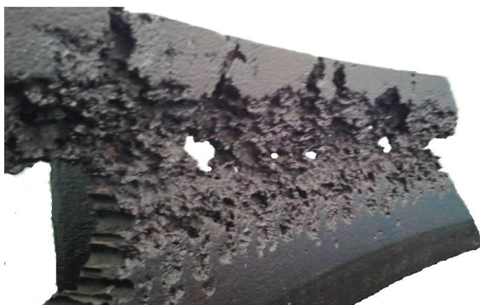
Рисунок 3.6- Пример разрушения материала стенок вследствие кавитация
