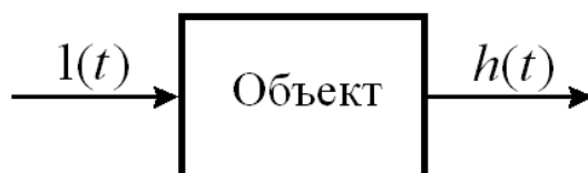
Рисунок 1.6 – Получение переходной характеристики объекта
