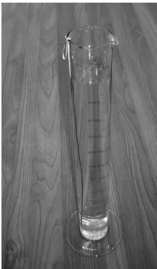
Рис. 46. Определение прозрачности воды методом кольца.
