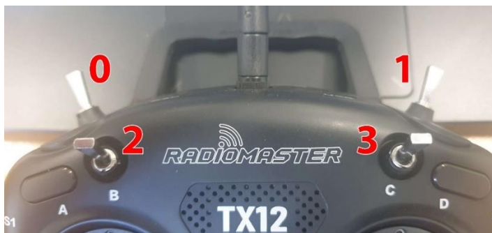
Рисунок 2 – Нумерация переключателей (тумблеров) на радиопередатчике Radiomaster TX12.
