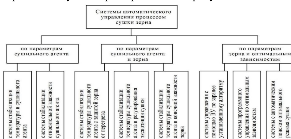
Рисунок 1 - Классификация систем автоматического управления процессом сушки зерна.
