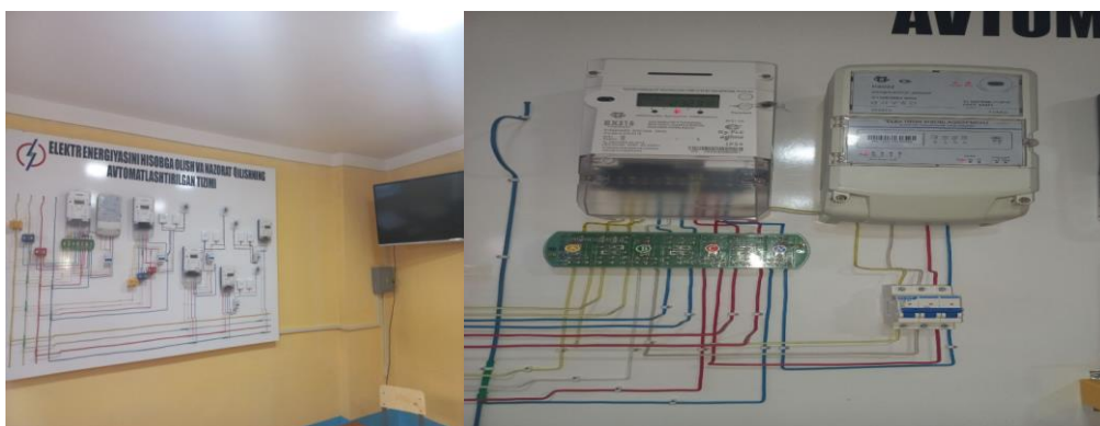
Рисунок 1– Лабораторный стенд АСКУЭ на кафедре «Электроэнергетика» .
