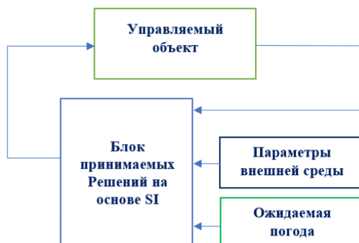
Рисунок 1 – Схема управления теплицы с использованием ИИ
