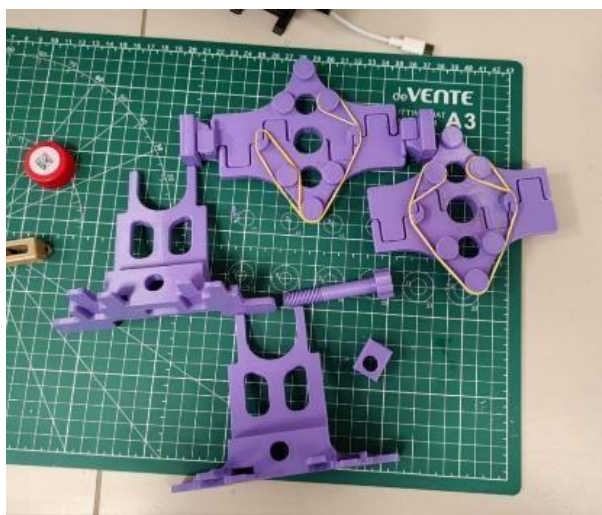
Рисунок 4 – Прибор для теста на разрыв в разобранном состоянии.
