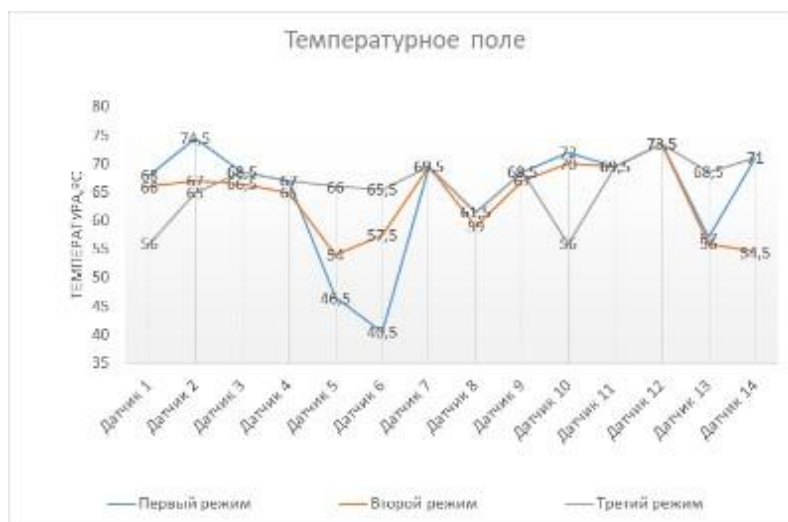
Рисунок 2 – Температурное поле внутри сушильного шкафа при трех режимах работы
