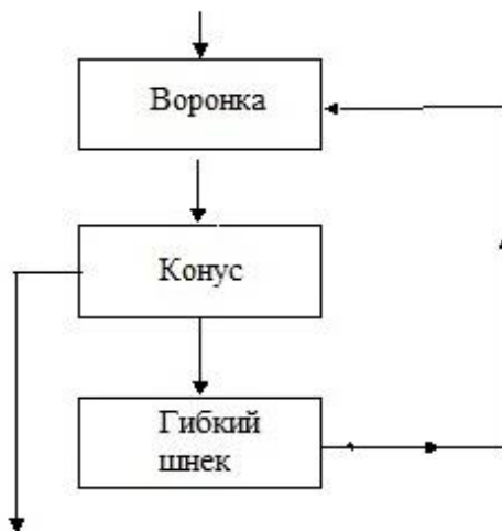
Рисунок 1 – Схема движения материального потока в первом смесителе
