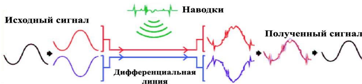
Рисунок 2.1.2 – Сравнение электрического сигнала при появлении шума на однопроводной шине и на дифференциальной.
