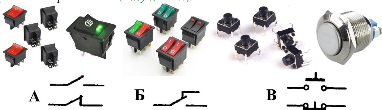
Рисунок 1.2.6 – Внешний вид и схематичное обозначение различных типов механических ключей и кнопок. А – нормально разомкнутый и нормально замкнутый выключатель, Б – переключатель с двумя положениями, В – нормально разомкнутая и нормально замкнутая кнопка с возвратным действием.
