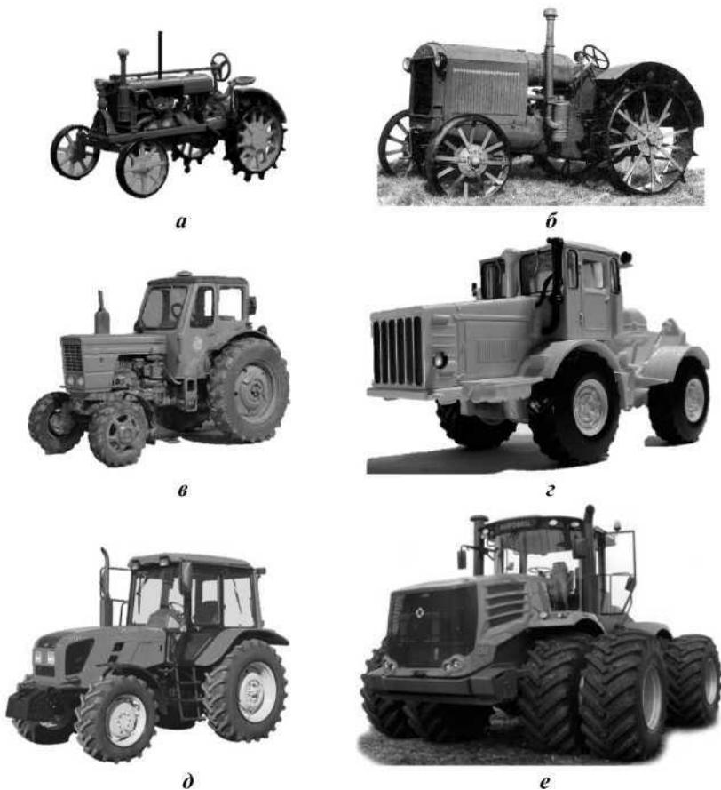
**Рисунок 3 - Представители первого (а, б), второго (в, г) и третьего поколения (д, е) тракторов: а - «Универсал»; б - СТЗ 15/30; в - МТЗ 52; г - К 700; д - BELARUS 923.4; е - К 9000**
